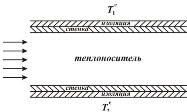
Рис. 3. Схема движения теплоносителя
