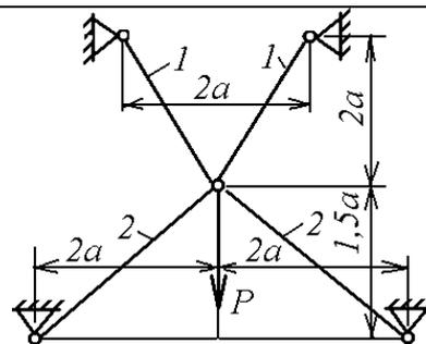
9. Стержень, изображенный на схеме, закреплен при  $t = -10\text{ }^{\circ}\text{C}$ . Определить напряжения при нагреве стержня на  $100\text{ }^{\circ}\text{C}$  при  $a = 0,2\text{ м}$ . Модули упругости меди и стали равны  $E_1 = 1.1 \cdot 10^5\text{ МПа}$ ,  $E_2 = 2 \cdot 10^5\text{ МПа}$ ,  $F = 2\text{ см}^2$ . Для стали коэффициент температурного расширения равен  $1.25 \cdot 10^{-5}\text{ 1/град}$ , для меди -  $2.5 \cdot 10^{-5}\text{ 1/град}$ .
