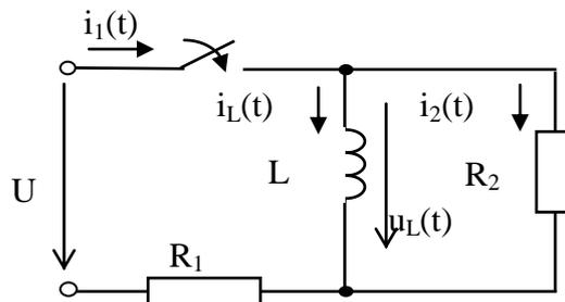
10. Катушка, индуктивность которой равна 0,12 Гн и сопротивление 1 Ом, включается на постоянное напряжение 30 В. Чему равна постоянная времени этой катушки? С какой скоростью нарастает ток в начальный момент? Чему равно установившееся значение тока?
