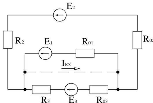
4. Запишите уравнение энергетического баланса для цепи. Определите мощности, отдаваемые источником  $E_3$  и потребляемые приемниками  $E_2$  и  $R_5$ .
