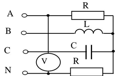
7. Определить токи в цепи, если источник питания симметричен и  $R = \omega L = 1/\omega C = 2 \text{ Ом}$ ;  $U_v = 20 \text{ В}$ .
