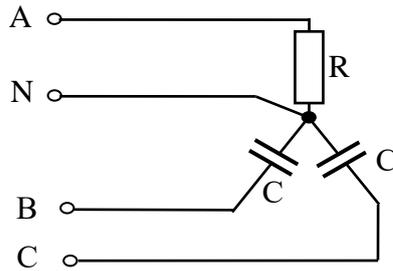
6. Линейное напряжение трехфазного трансформатора, соединенного звездой с нулевым проводом, равно 220 В. В фазе А включено 30 одинаковых ламп (40 Вт), 127 В каждая), в фазе В – 20 ламп, а фаза С – 10 ламп. Определить ток в нейтрали и напряжение на каждой группе ламп при обрыве нулевого провода.
