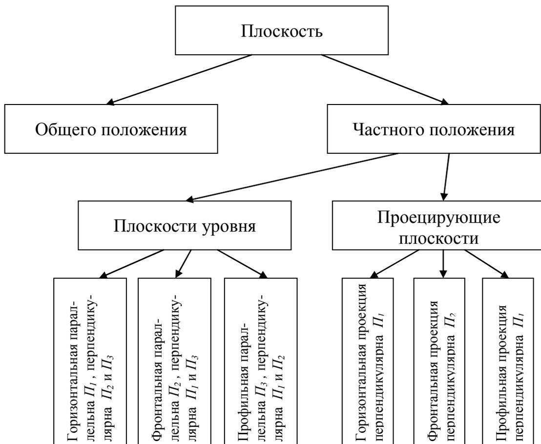
*Различные положения плоскости относительно плоскостей проекций*
