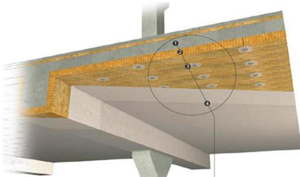
1 – железобетон, 2 – огнезащита, 3 – крепление, 4 – штукатурка.
