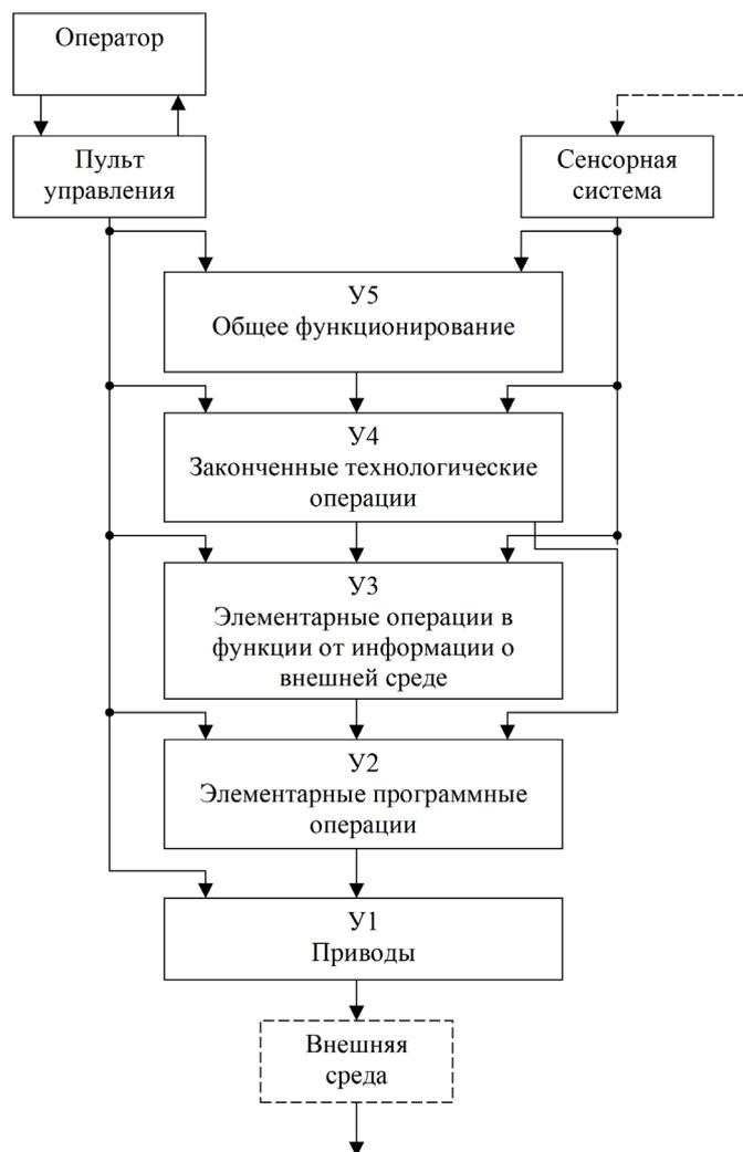
Рис. 1.7. Структура системы управления адаптивным роботом
