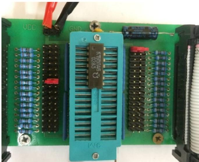
Рис. 8.3. Правильно установленная микросхема
