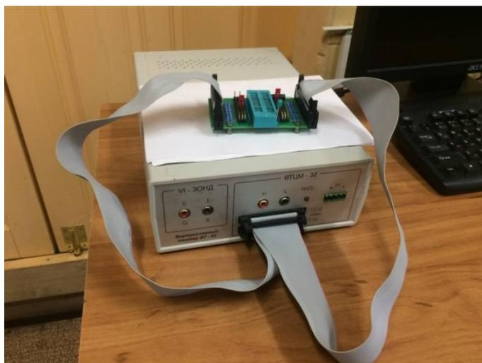
Рис. 2.3. Подключение шлейфов установки «ВТ-02» к внесхемному тестеру
