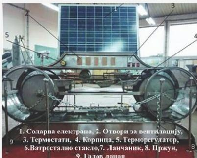
Солнечная сушилка используется для сушки фруктов (яблок, слив, груш, фундука, инжира ...). Процесс сушки занимает около 24 часов в зависимости от толщины среза (оптимальная толщина составляет 5 мм). Оптимальная температура сушки зависит от типа фруктов и определяется механическим нагревом электронов. Сушилка выполнена по принципу возобновляемых источников энергии, то есть солнечной
