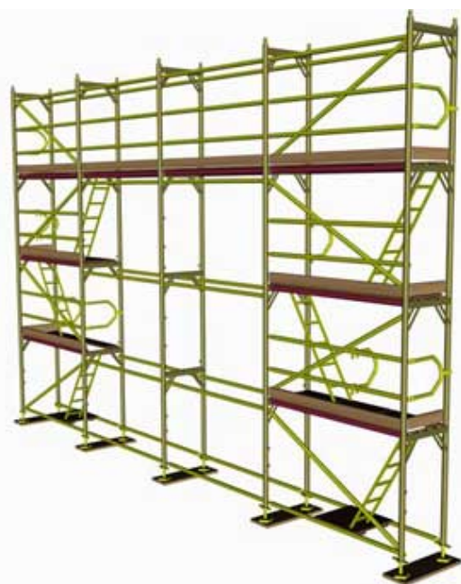
Рис. П. 3.28. Строительные трубчатые леса рамного типа
