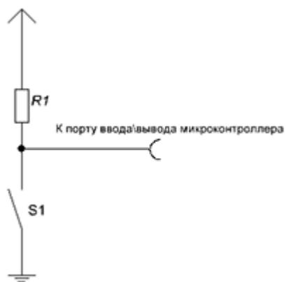
**Рис. П2.6.** Схема подключения тумблера к порту МК
