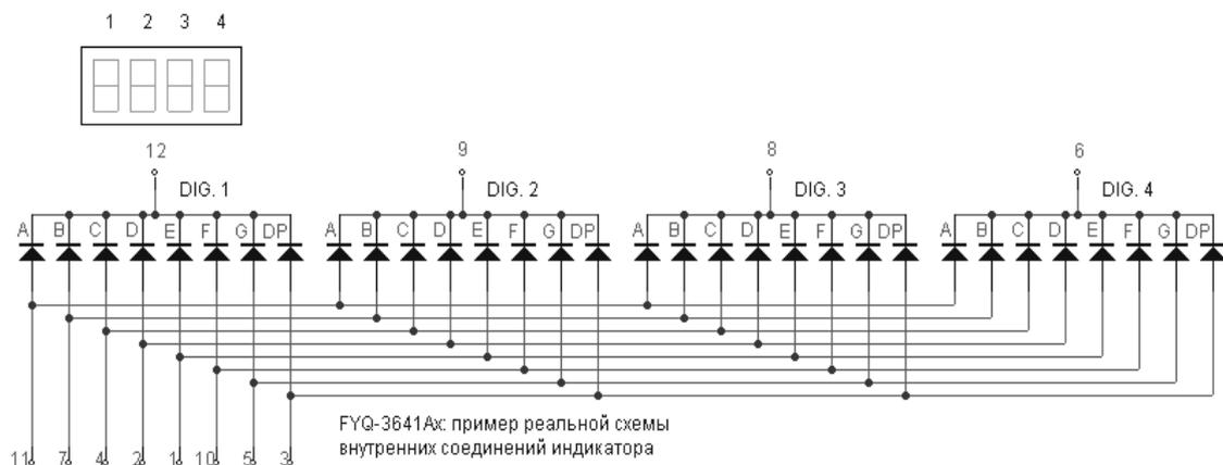
**Рис. ПЗ.9.** Схема многоразрядного светодиодного индикатора
