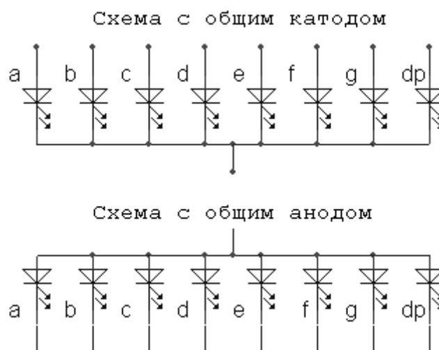
**Рис. ПЗ.1.** Схемы питания светодиодов в индикаторе
