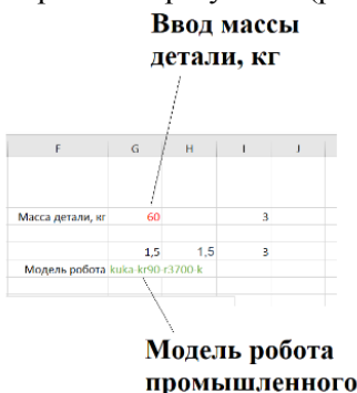
Рис. 7. Автоматизированный выбор модели робота промышленного
