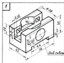
14. Выполнить сложный разрез детали.
