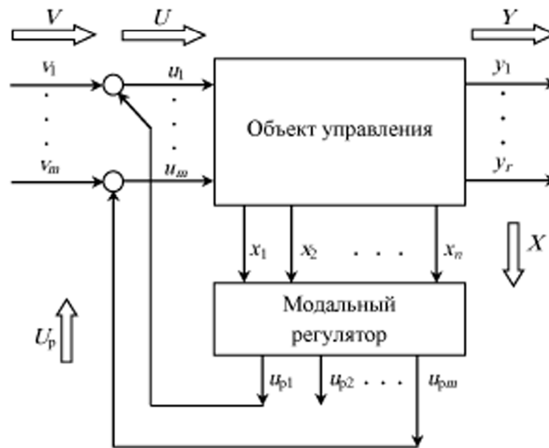
Структура системы с модальным управлением
