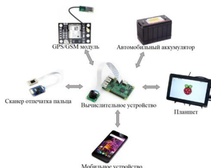
Рис. 1. Обобщенная структурная схема системы идентификации
