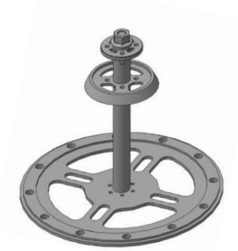
Рис. 2. Приспособление для приварки коллекторов
