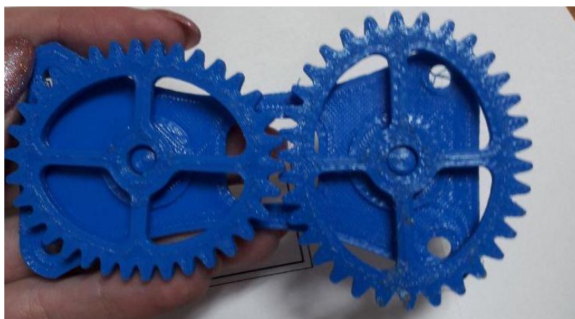
Рис. 3. Прототип модели некруглой цилиндрической зубчатой передачи
