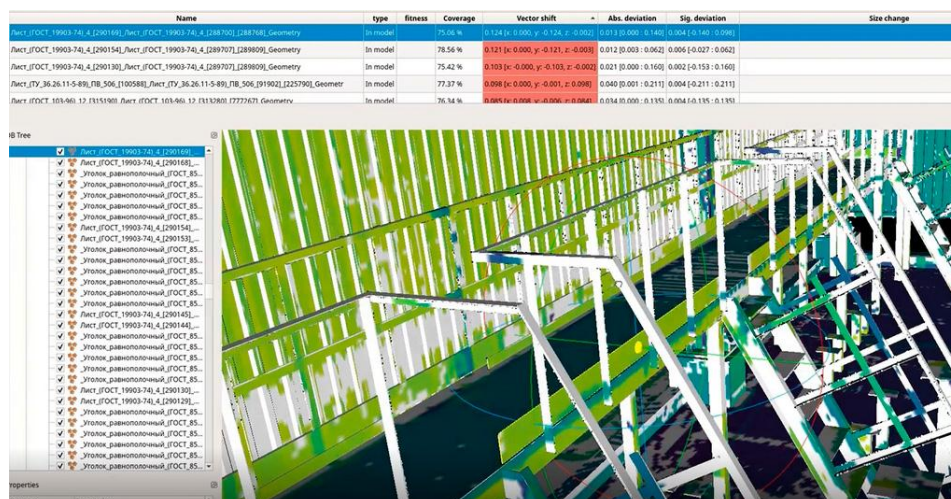
Визуализация ОТ с показанными отклонениями от CAD-модели
