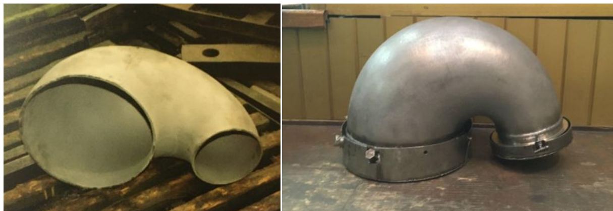
Рис. 5. Бесшовный газовод и скомплектованный газовод с блоком форсунок, фланцем, наконечниками и штуцерами
