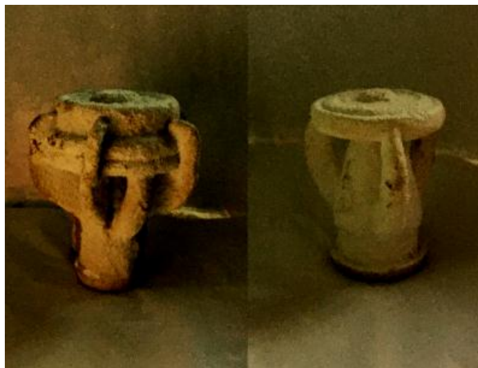
Рис. 2. Отливки ЖРД лопаточного типа
