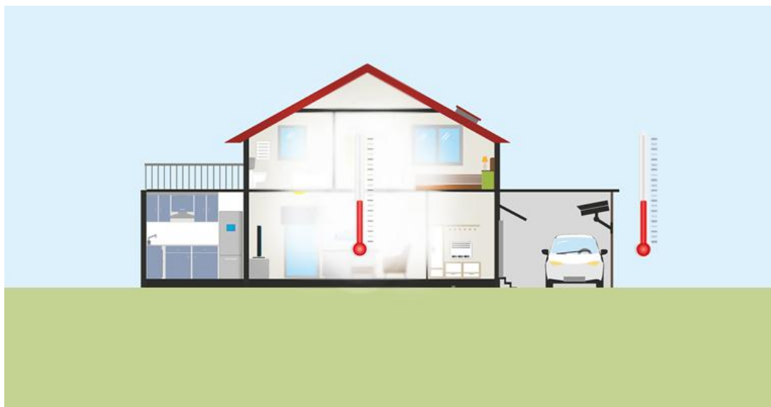
Рис. 2. Визуализация разницы внутренних и внешних температур, которые создают эффекты вентиляции, обусловленные плавучестью, такие как вентиляция
