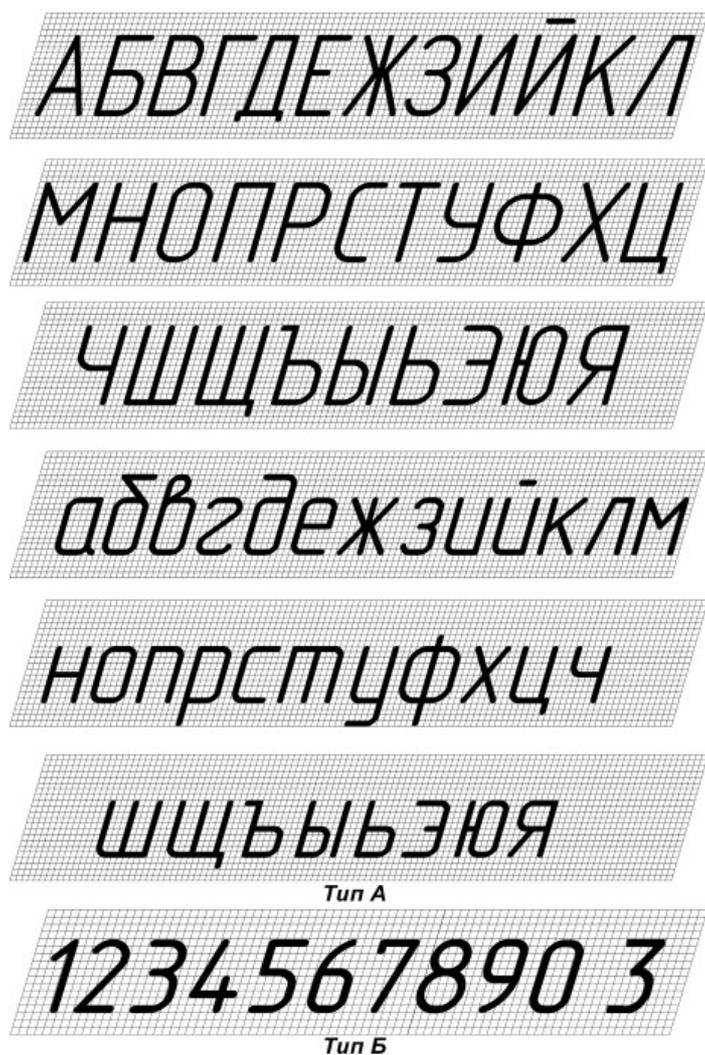
**Рис. 2.5.** Вписывание букв шрифта типа А и Б с наклоном в сетку
