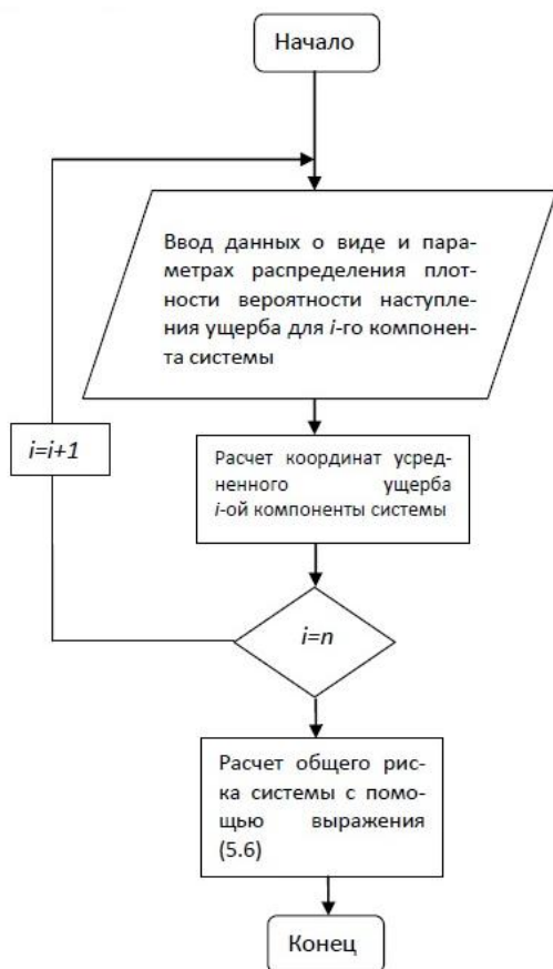
Рис. 2.5. Алгоритм расчёта общего риска системы на основе усредненных оценок риска в её компонентах
