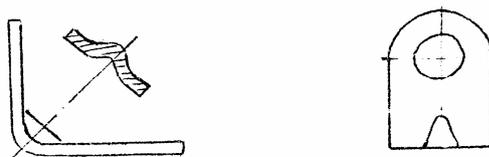
Рис. 10. Выдавка угла для повышения жесткости.
