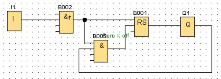
Решение задачи основано на работе RS-триггера. При  $Q = 0$  одиночным импульсом с помощью блока B002 выход Q переводится в единицу. При  $Q = 1$  тот же одиночный импульс (фиксируется нажатие выключателя, т.е. входа I) подается также на блок B003, который переводит свой выход в единицу только при  $Q = 1$ . С выхода блока B003 высокий уровень сигнала сбрасывает RS-триггер. Схема приведена в первоначальное состояние.
