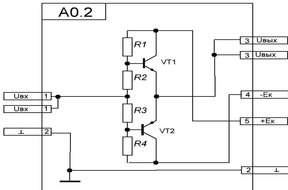
а) Схема электрическая принципиальная оконечного каскада УМ при работе транзисторов в режиме В
