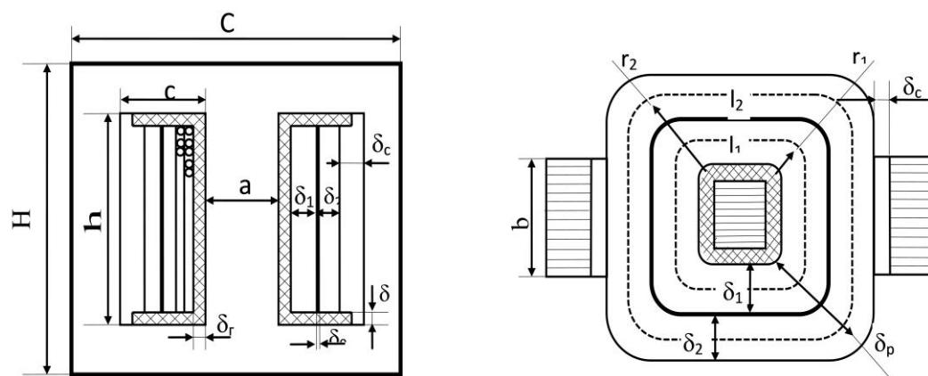
Размещение обмоток на магнитопроводе
