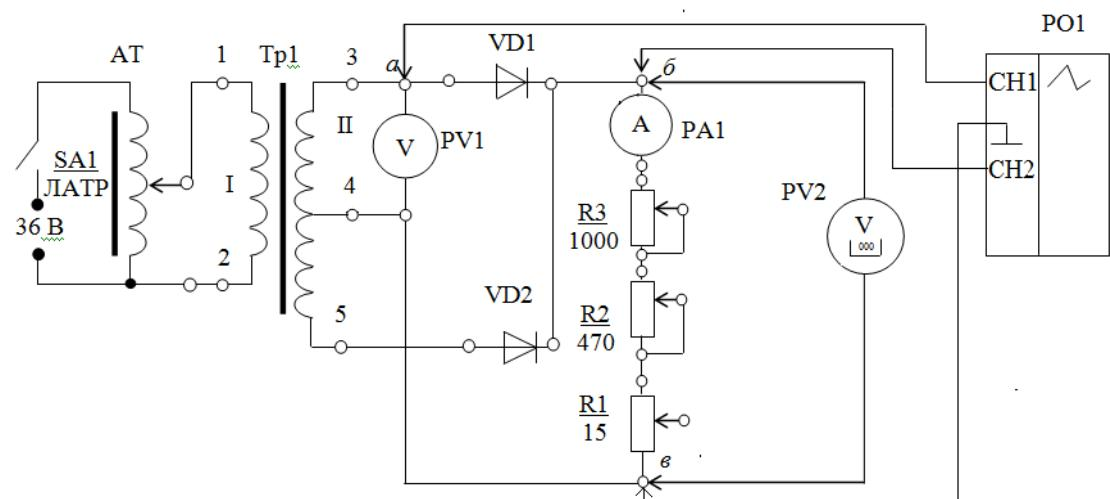
Схема лабораторной установки для проведения исследований
