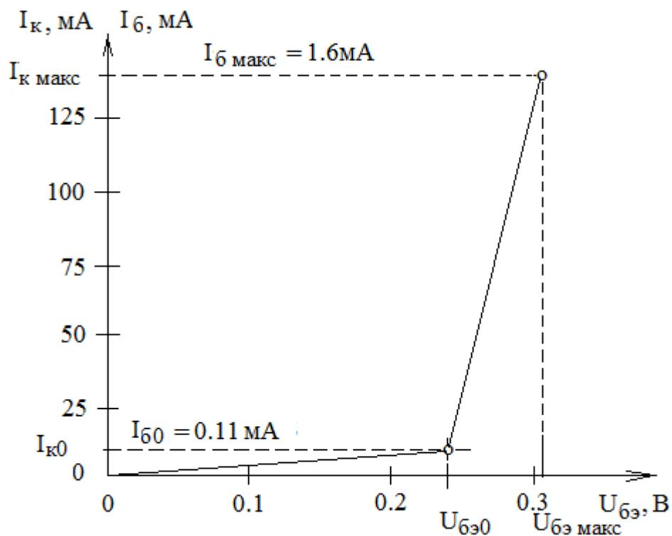
а) Линейно-кусочная аппроксимация входной и проходной ВАХ транзистора КТ503Б, включенного по схеме с ОЭ
