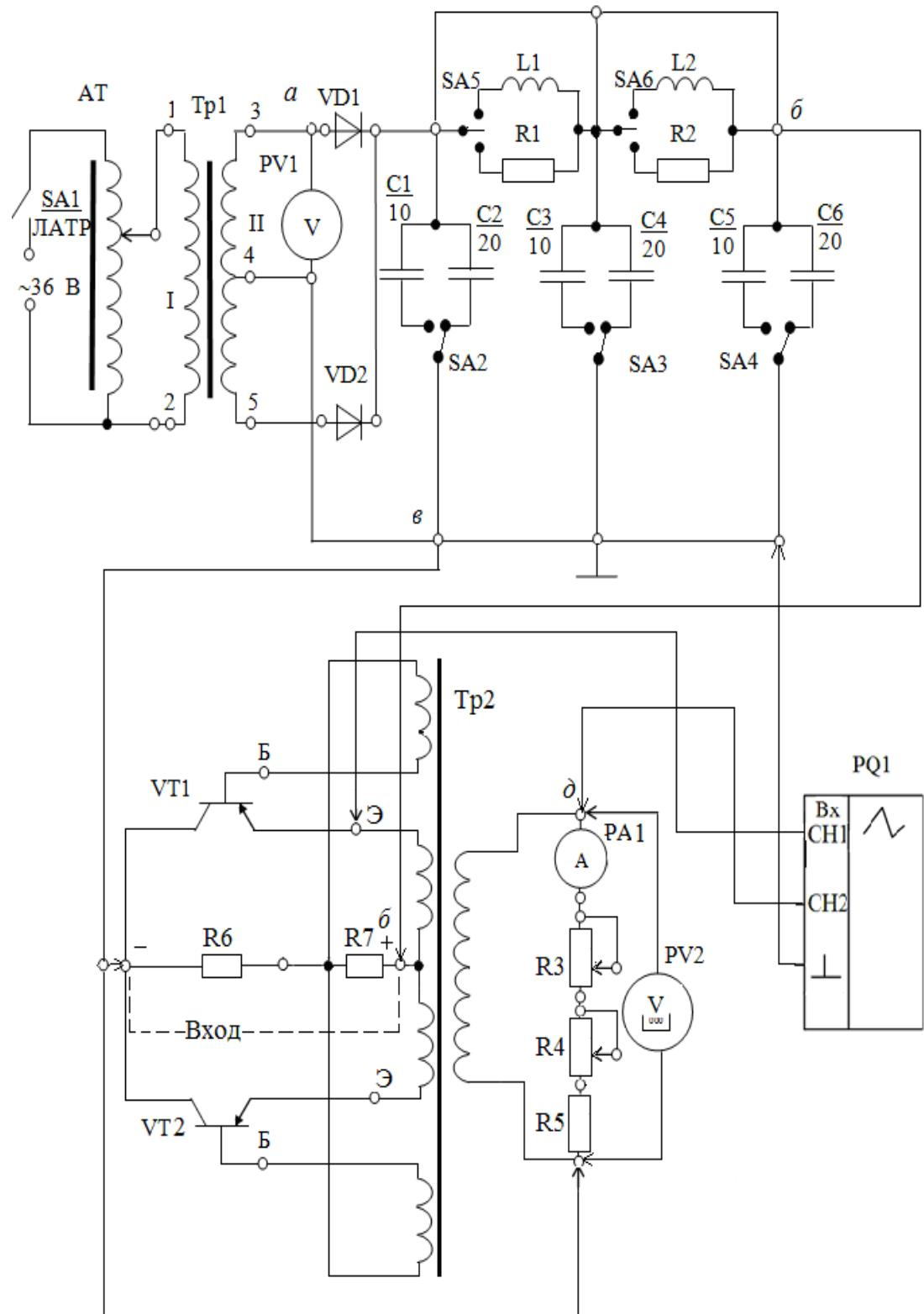
Схема лабораторной установки для проведения измерений параметров
