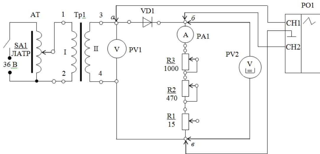
Чему равны частота и коэффициент пульсации на выходе схемы выпрямления, если частота сети равна 50 Гц?
