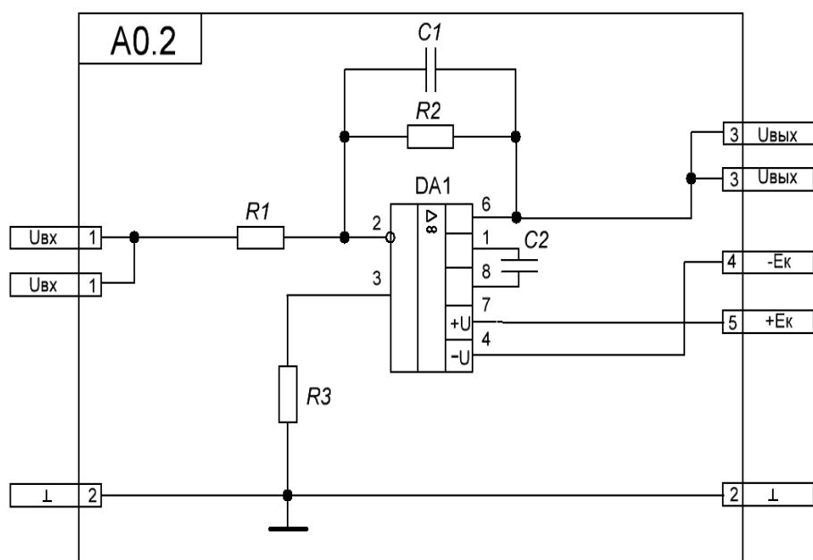
а) Схема электрическая принципиальная активного фильтра низких частот первого порядка на основе интегрирующей RC-цепочки, включенной на входе ОУ
