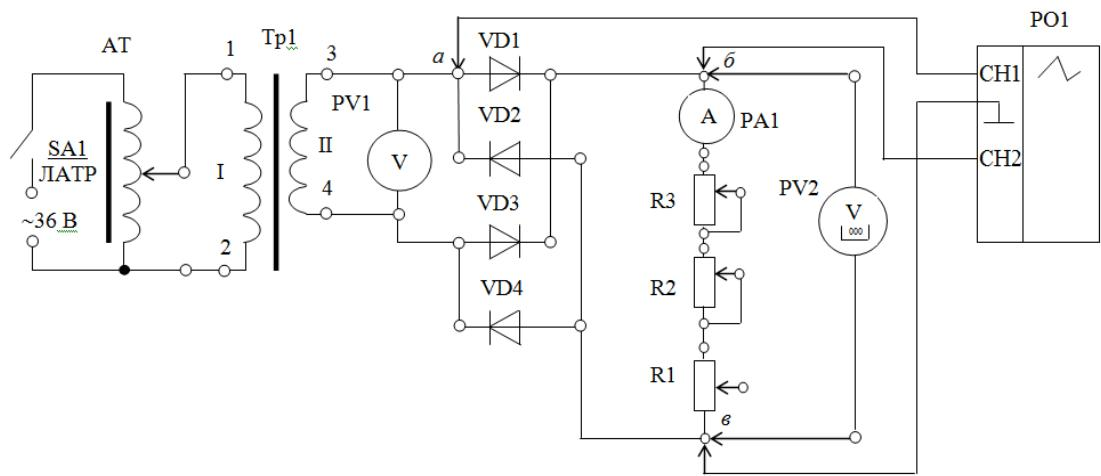
Чему равны частоты гармоник напряжения на выходе схемы выпрямления, если частота сети равна 50 Гц?
