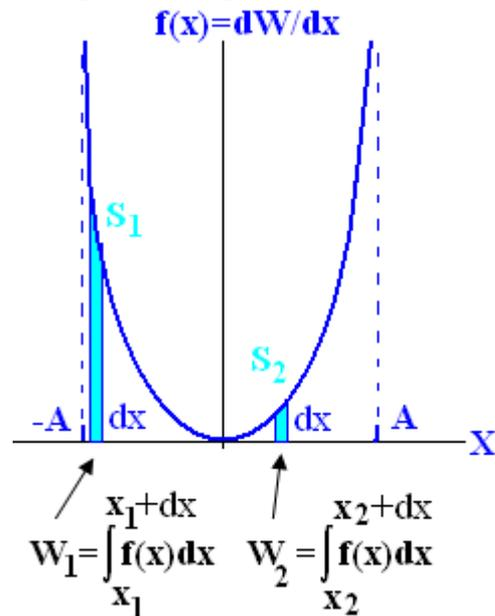
Рис. 3– Плотность вероятности нахождения гармонического осциллятора в интервале координат  $(-A, A)$  на оси  $X$ .
