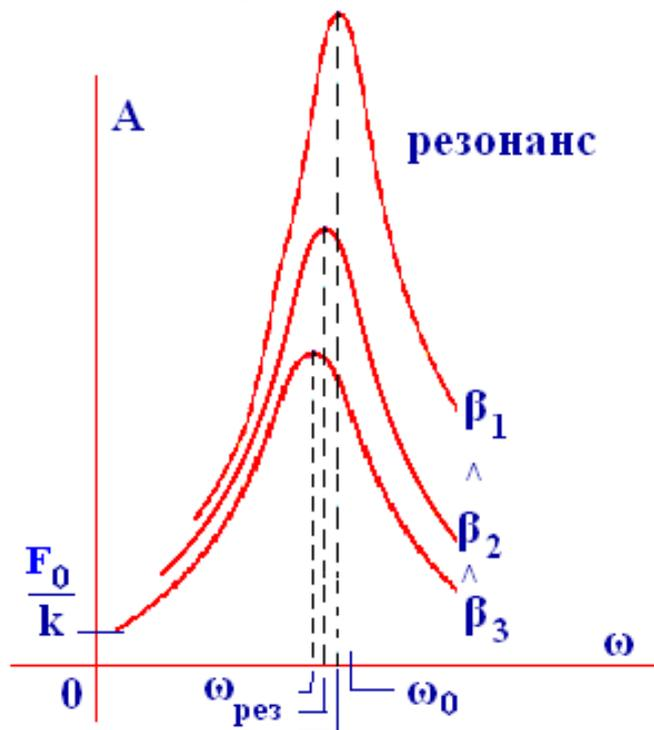
*Рис. 5– Графическая иллюстрация явления резонанса – амплитудно-частотные характеристики (АЧХ) вынужденных колебаний механической системы; с увеличением сопротивления среды ( $\beta_1 < \beta_2 < \beta_3$ ) уменьшается резонансная частота ( $\omega_1 > \omega_2 > \omega_3$ ).*
