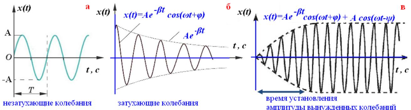
Рис. 4– Графическая иллюстрация свободных незатухающих (а), затухающих (б) и вынужденных (в) колебаний механической системы.
