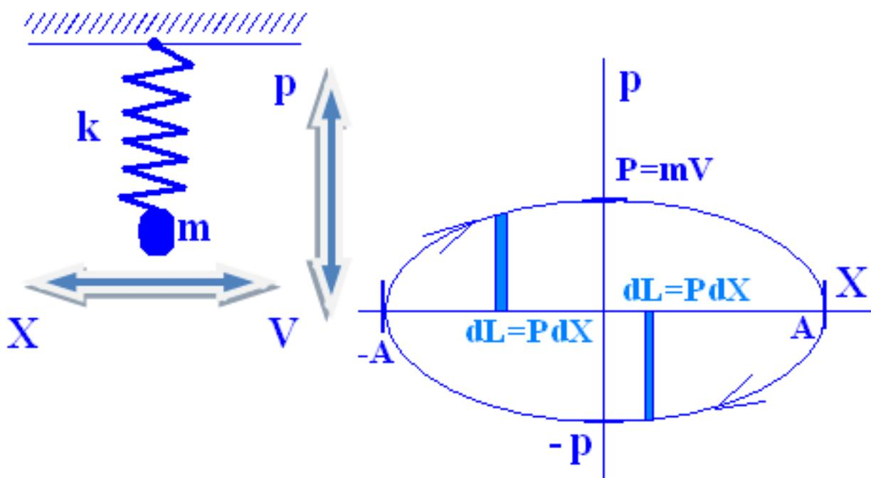
Рис. 2– Фазовая траектория гармонического осциллятора в координатной плоскости  $(X, p)$ .
