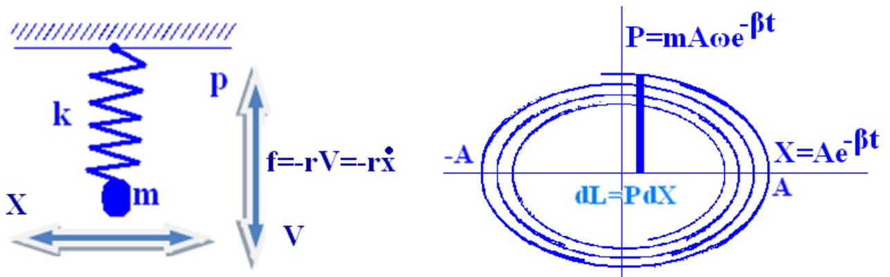
Рис. 3– Фазовая траектория осциллятора, совершающего затухающие колебания, в координатной плоскости ( $X$   $p$ ).
