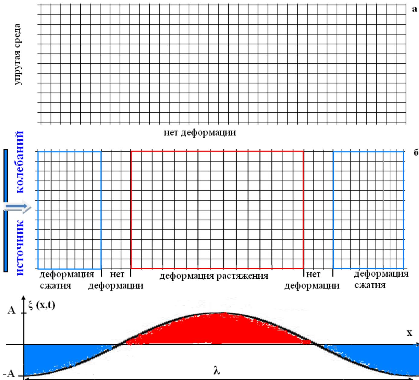
Рис. 1. – Иллюстрация процесса распространения деформации в упругой среде. Направление колебаний частиц упругой среды и направление распространения волнового фронта совпадают – плоская, продольная волна
