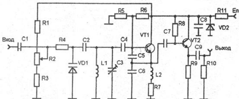
Рис.П2.1. Принципиальная схема частотно-модулированного LC генератора
