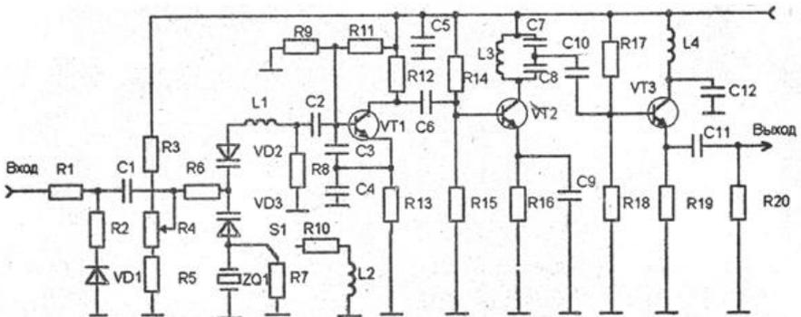
Рис.ПЗ.1. Принципиальная схема кварцевого ЧМ генератора
