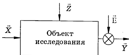
Рис. 13. Схема объекта исследования при построении экспериментальной факторной модели
