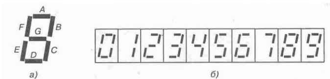
Рис. 3. Обозначение сегментов (а) и цифры, высвечиваемые на семисегментном индикаторе (б)
