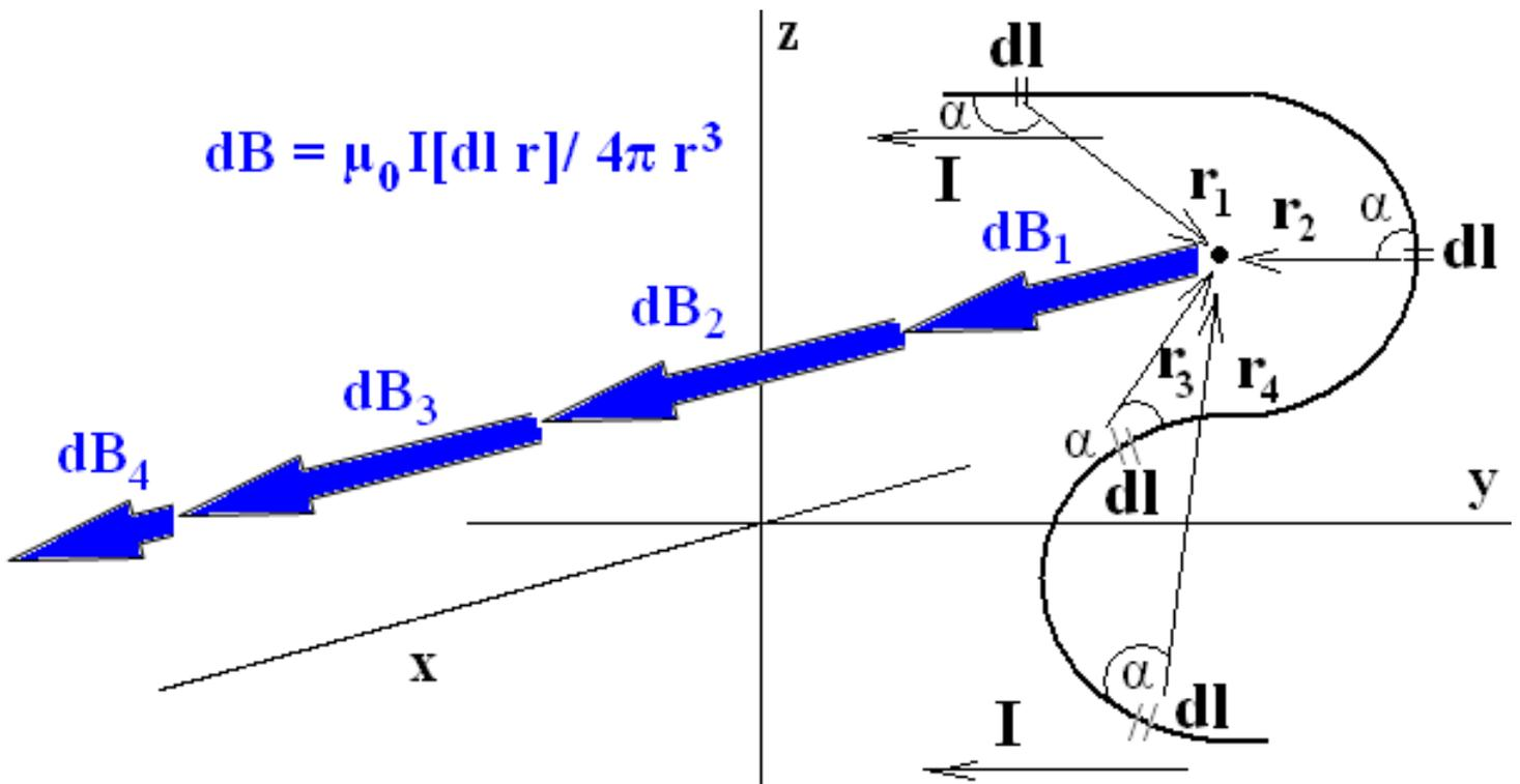
Рис. 6 Схема, иллюстрирующая Закон Био – Савара – Лапласа. Приращение вектора магнитной индукции от соответствующих участков проводника при протекании тока  $\mathbf{I}$ . Вектор магнитной индукции  $\mathbf{B}$ , участок с током  $d\mathbf{l}$ , и радиус вектор  $\mathbf{r}$  составляют правую тройку ортогональных векторов.
