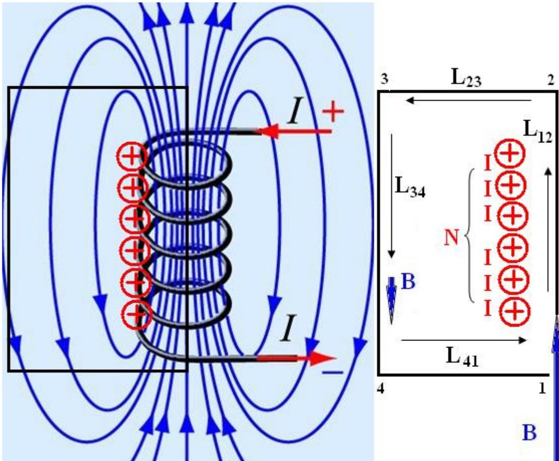
Рис. 10 Иллюстрация теоремы о циркуляции вектора магнитной индукции на примере соленоида и воображаемого прямоугольника 1234.  $\mathbf{B}l = \mathbf{B}_{12}l_{12} + \mathbf{B}_{23}l_{23} + \mathbf{B}_{34}l_{34} + \mathbf{B}_{41}l_{41} = NI$ . Поскольку,  $\mathbf{B}_{23}l_{23} = -\mathbf{B}_{41}l_{41}$ , а  $\mathbf{B}_{34}l_{34} \ll \mathbf{B}_{12}l_{12}$  в силу малости  $\mathbf{B}$  на участке 34, следует:  $\mathbf{B}_{12}l_{12} = NI$ .
