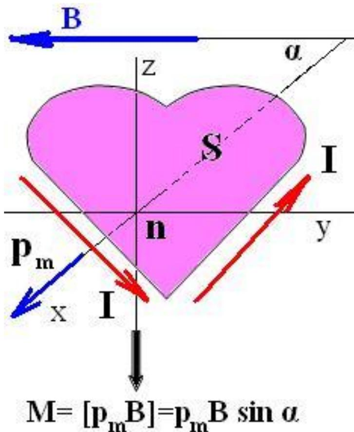
Рис. 7 Схема, иллюстрирующая взаимодействие магнитного поля и замкнутого плоского контура с током. Вектор магнитного момента контура с током совпадает с осью X, т.к. контур с током лежит в плоскости YZ. Если вектор  $\mathbf{B}$  и ось Y коллинеарные возникает механический момент сил  $\mathbf{M}$  коллинеарный с осью Z. Момент сил  $\mathbf{M}$  ортогонален векторам  $\mathbf{B}$  и  $\mathbf{p}_m$ .
