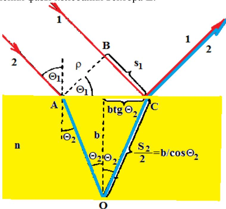
Рис. 19 Иллюстрация наложение двух когерентных волн, образованных в результате отражения света от первой границы раздела воздух/стекло и второй - стекло/воздух.
