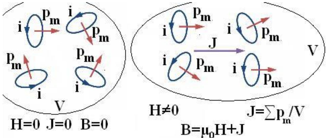
Рис. 11 Иллюстрация процесса намагничивания вещества за счет ориентации микроскопических токов и соответствующих им магнитных моментов атомов и молекул
