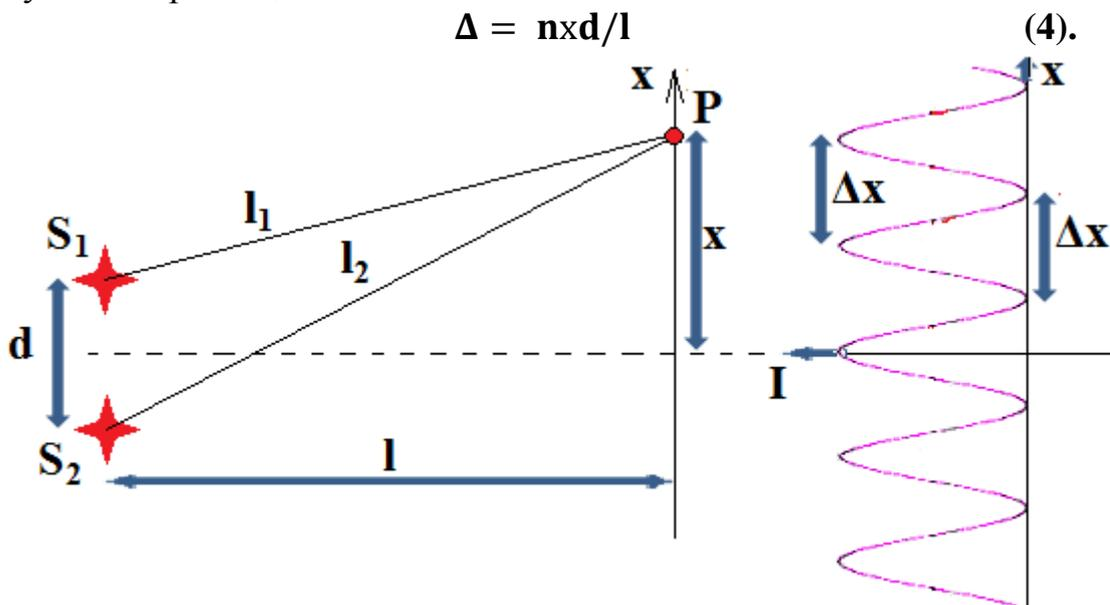
Рис. 18 Иллюстрация формирования интерференционной картины на экране ( $I=f(x)$ ) наложением двух когерентных волн (от источников  $S_1$  и  $S_2$ ), образованных в результате дифракции света на щели шириной  $d$ .
