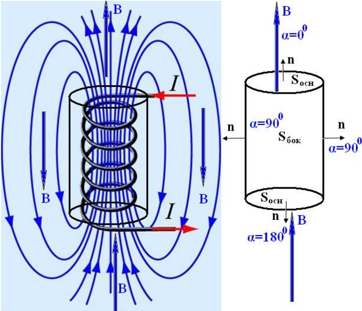
Рис. 9 Иллюстрация теоремы Гаусса для потока вектора магнитной индукции на примере соленоида внутри воображаемого цилиндра. Магнитный поток через боковую поверхность равен нулю ( $\alpha=90^\circ$ ), а через нижнее и верхнее основания цилиндра магнитные потоки равны по величине и противоположны по знаку. В итоге, суммарный поток  $\Phi_B=0$ .
