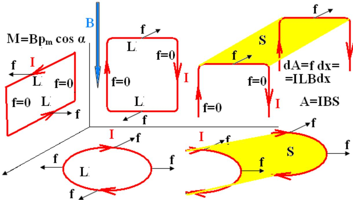
Рис. 12 Схема пространственного расположения и действия сил и моментов сил со стороны магнитного поля на замкнутые и незамкнутые контуры с током  $I$ , соответственно. Работа в магнитном поле, совершаемая при перемещении проводника с током.
