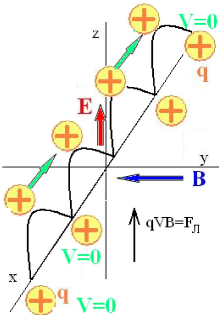
Рис. 4 Схема совместного действия скрещенных (под углом  $90^\circ$ ) электрического и магнитного полей на подвижный электрический заряд. Траектория движения заряда – кривая линия в плоскости  $XZ$ : вектор скорости  $V$ , вектор магнитной индукции  $B$  и вектор силы Лоренца  $F_L=q[VB]$  перпендикулярны друг другу.
