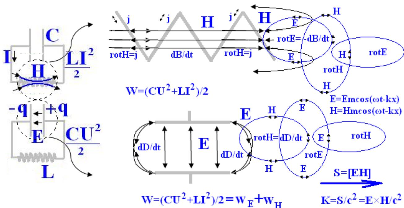
Рис. 16 – Иллюстрация вихревого характера электромагнитного поля.
