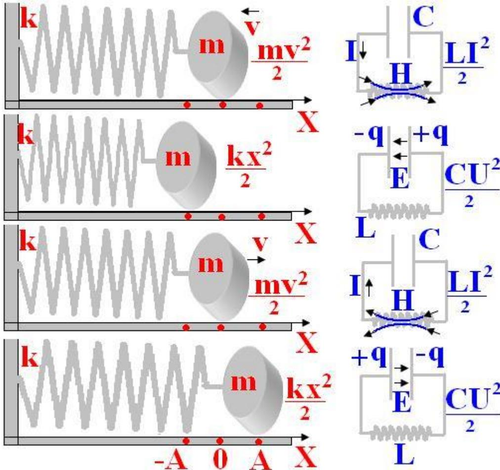
Рис. 15 – Ряд превращений механической энергии пружинного маятника и аналогичная последовательность для энергии электрического и магнитного полей при незатухающих колебаниях в замкнутом контуре, содержащем индуктивность и ёмкость без активного сопротивления.
