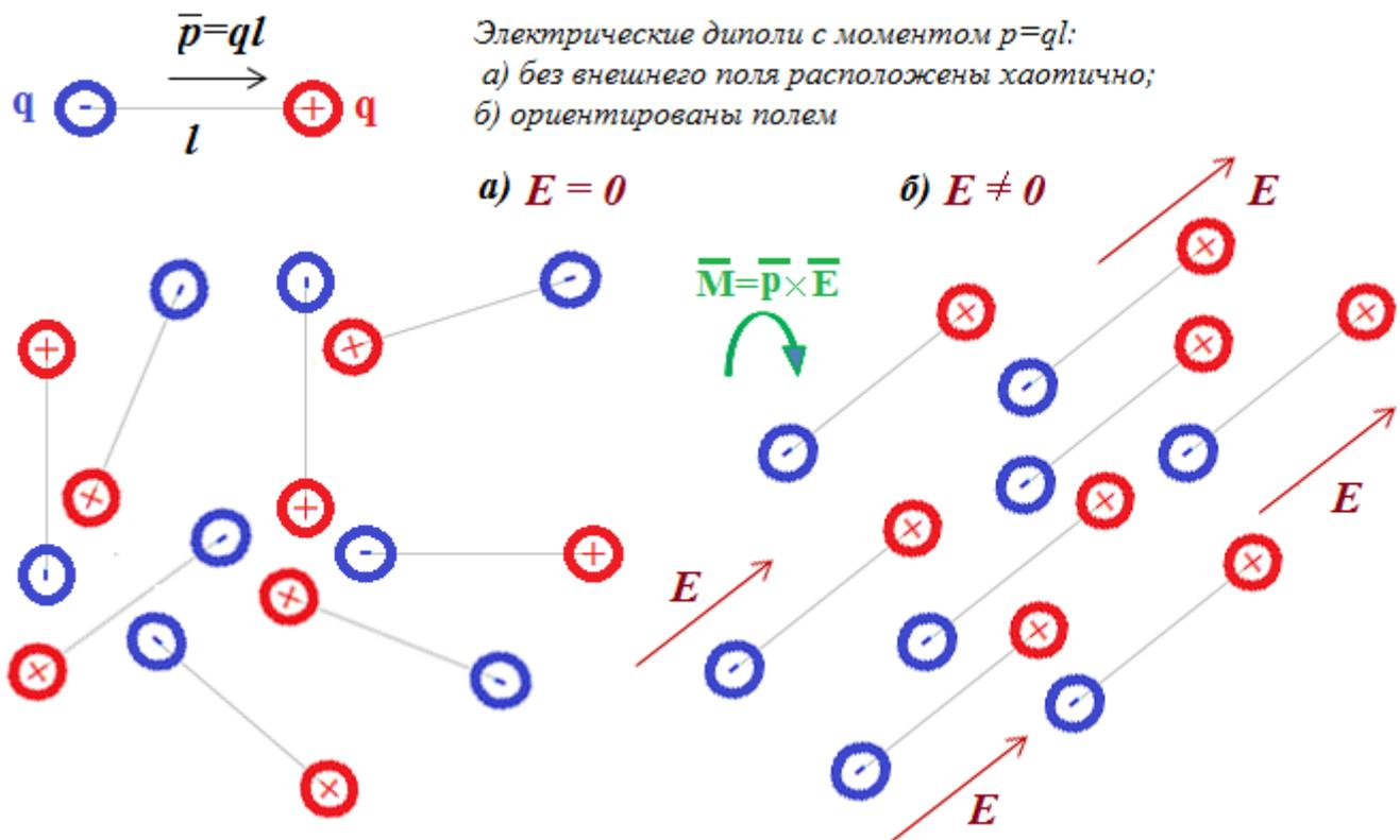
Рис. 2. – Ориентирующее влияние электрического поля ( $\mathbf{E}$ ) на электрические диполи с электрическим моментом  $\vec{p} = q\vec{l}$ ; вращение диполей под действием вращающего момента  $\mathbf{M}$ .
