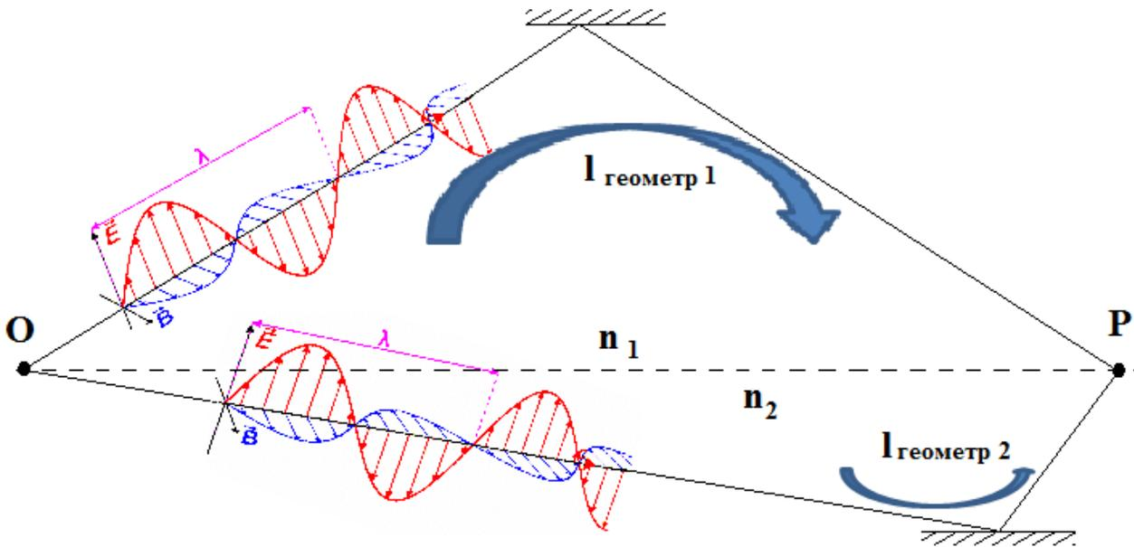
Рис. 17 Иллюстрация наложение двух когерентных волн, когда после разделения на две волны в т. О они встречаются в т. Р
