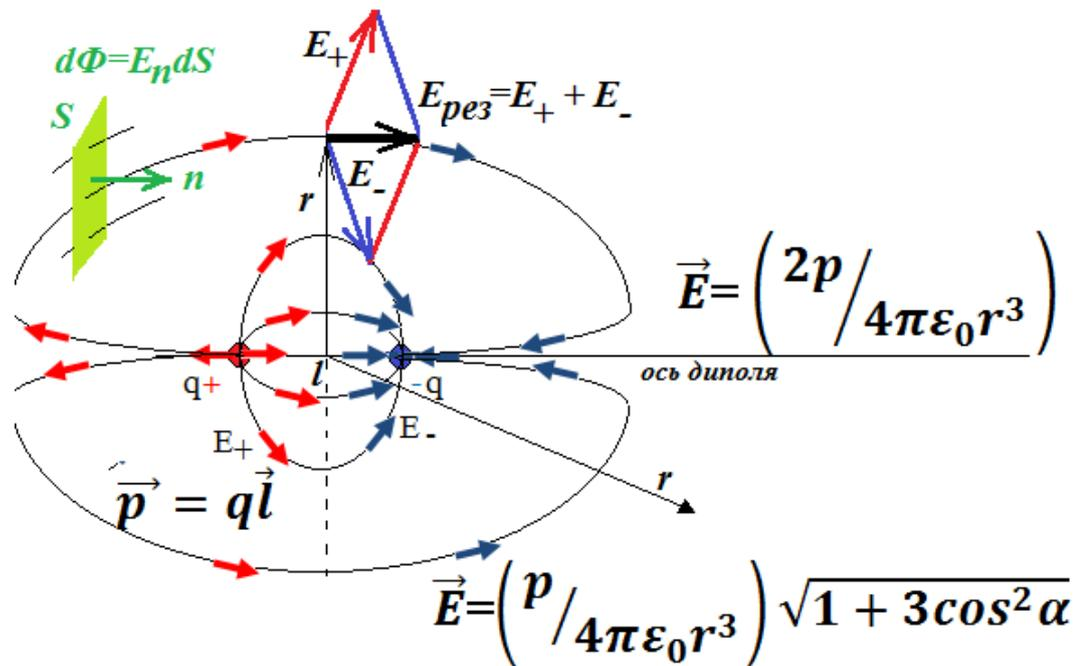
Рис. 1. – Иллюстрация силовых линий, вектора напряженности ( $E$ ) электрического поля и потока вектора ( $\Phi$ ), создаваемых диполем с электрическим моментом  $\vec{p} = q\vec{l}$
