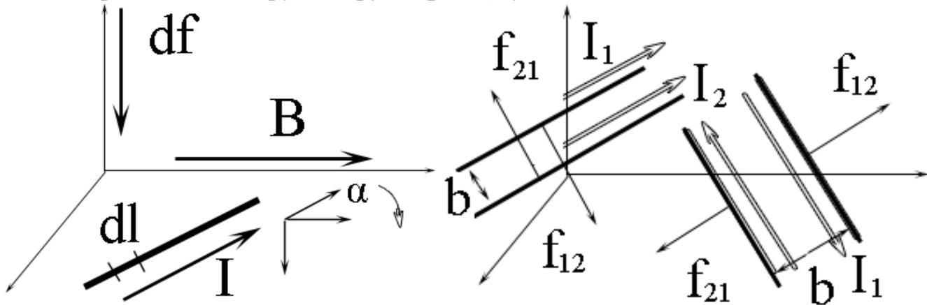
Рис.1 Схема действия магнитного поля на проводник с током. Рис.2 Сила Ампера
