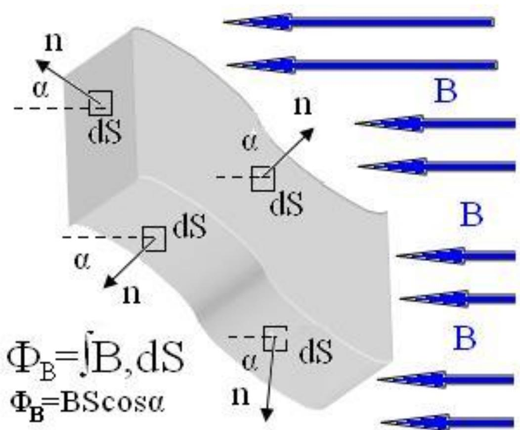
Рис. 8 Схема, иллюстрирующая величину магнитного потока через произвольную поверхность. Магнитный поток имеет смысл плотности силовых линий магнитного поля на заданной поверхности. Магнитный поток имеет положительный знак, когда угол  $\alpha < 90^\circ$ , отрицательный при  $\alpha > 90^\circ$  и равен нулю если  $\alpha = 90^\circ$ .
