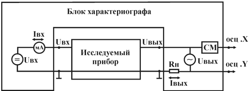
Рис. П.1. Упрощенная схема характерографа. Испытуемый прибор представлен четырехполюсником. СМ – схема масштабирования координаты X
