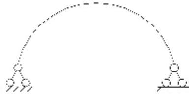
18. Определите число избыточных связей стержневой системы
