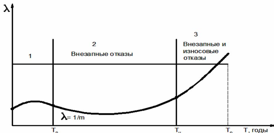
Рис. 1.4. График интенсивности отказов элементов как функция времени эксплуатации: 1- период приработки; 2- период нормальной эксплуатации; 3-период интенсивного износа
