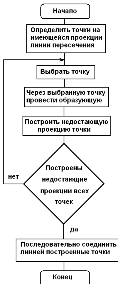
Рис. 2.2 Блок-схема алгоритма построения линии взаимного пересечения поверхностей методом образующих
