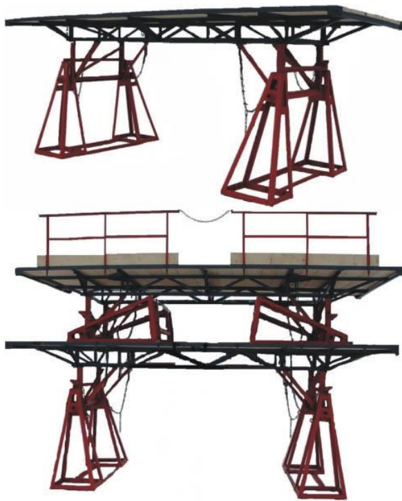
Рис. П. 3.19. Инвентарные шарнирно-панельные подмости а – вид сбоку при кладке третьего яруса; б – то же, второго яруса
