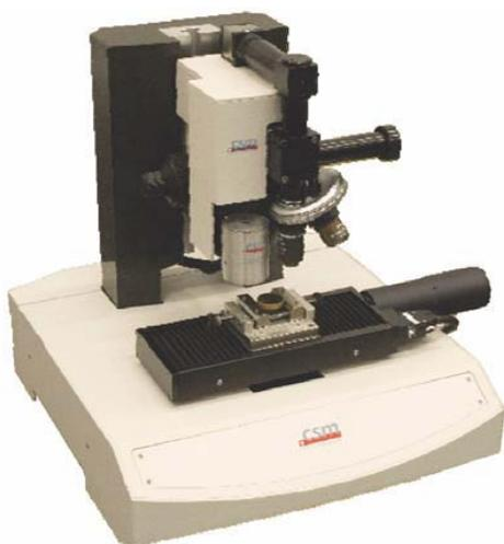
Рис. 2.8 Нанотвердомер Nano-Hardness Tester
