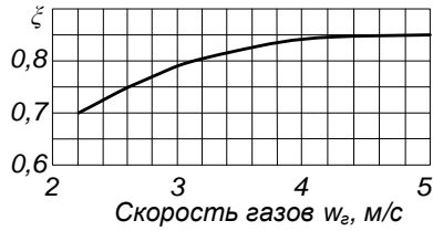
Рис. П1. 11. Коэффициент использования ширмовых пароперегревателей (продолжение)
