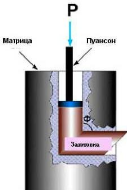
Рис. 6.10. Схема процесса РКУП
