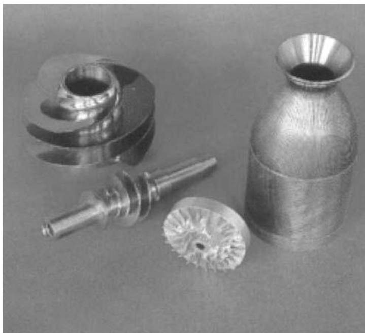
Рис. 5.9. Детали, целиком обработанные на станках с ЧПУ
