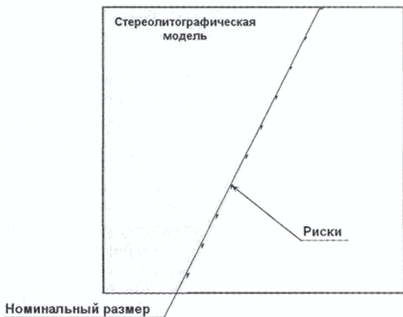
Рис.7.7. Поверхность модели после шлифования до исчезновения рисок
