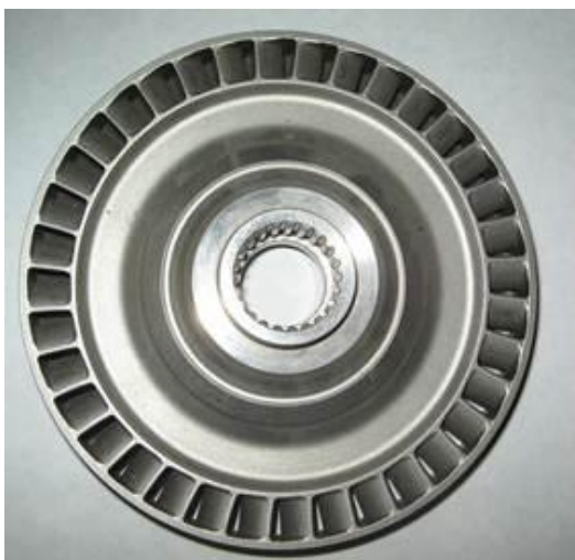
Рис. 5.6. Турбина с закрытыми узкими межлопаточными каналами, выполненными в цельной заготовке
