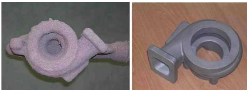
Рис. 6.4. Оболочковая форма и и отливка корпуса турбины, полученные по восковой синтез-модели
