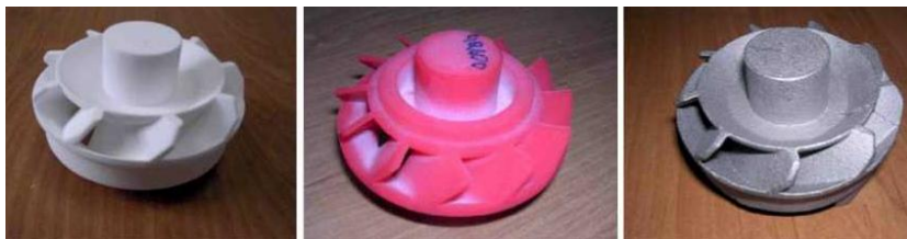
Рис. 6.2. Полистирольная модель (после выращивания и инфильтрации) и отливка (чугун)
