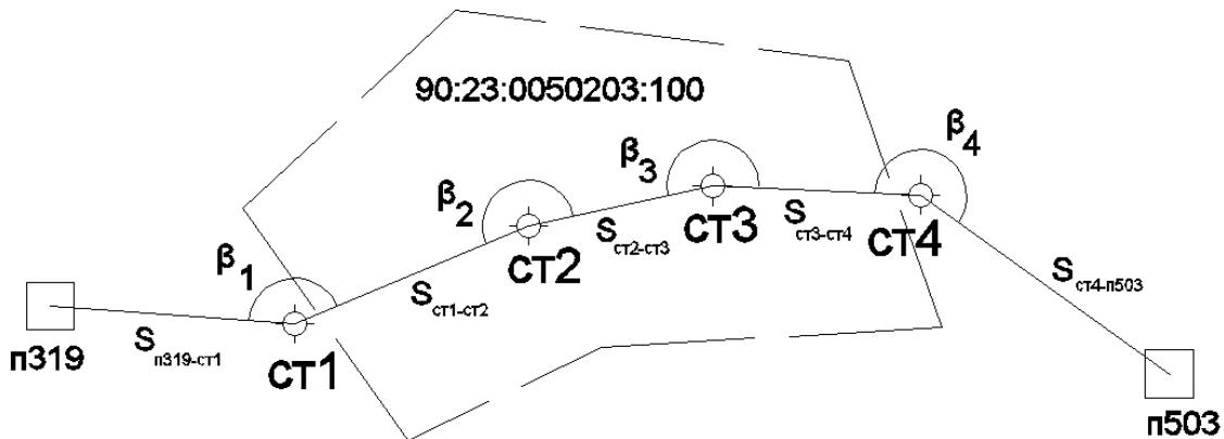
Рис. 2.4. Схема хода съемочного обоснования
