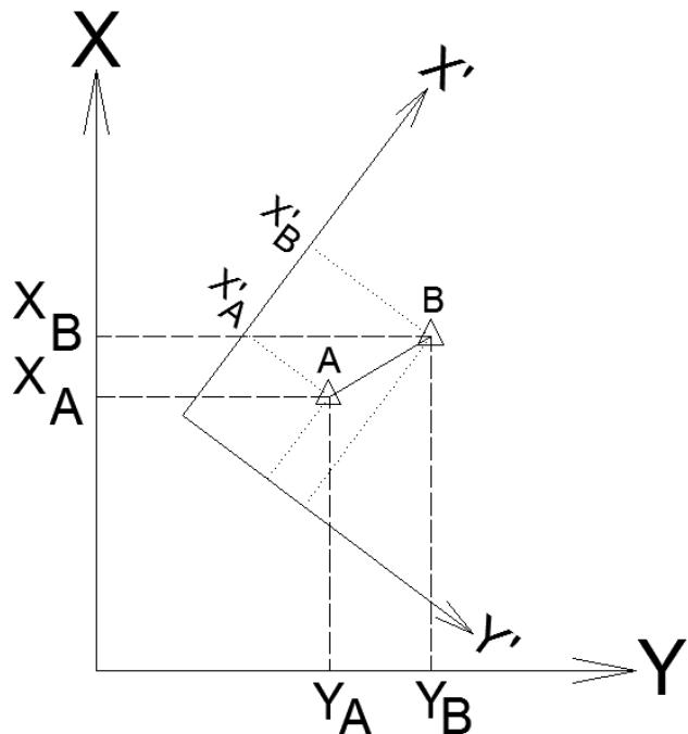
Рис. 1.1. Взаимное расположение осей МСК (X, Y) и условной СК ( $x'$ ,  $y'$ )
