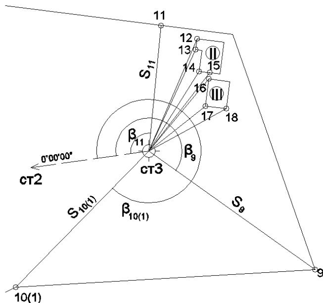
Рис. 3.7. Абрисы полевых измерений на станции 3
