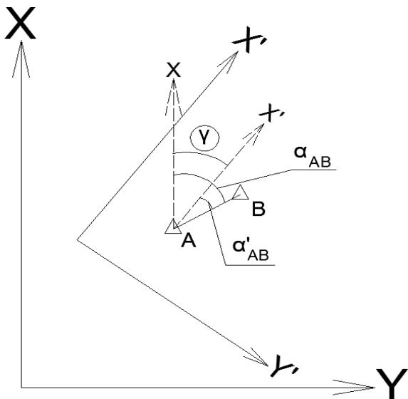
Рис. 1.2. Угол взаимного разворота осей систем координат
