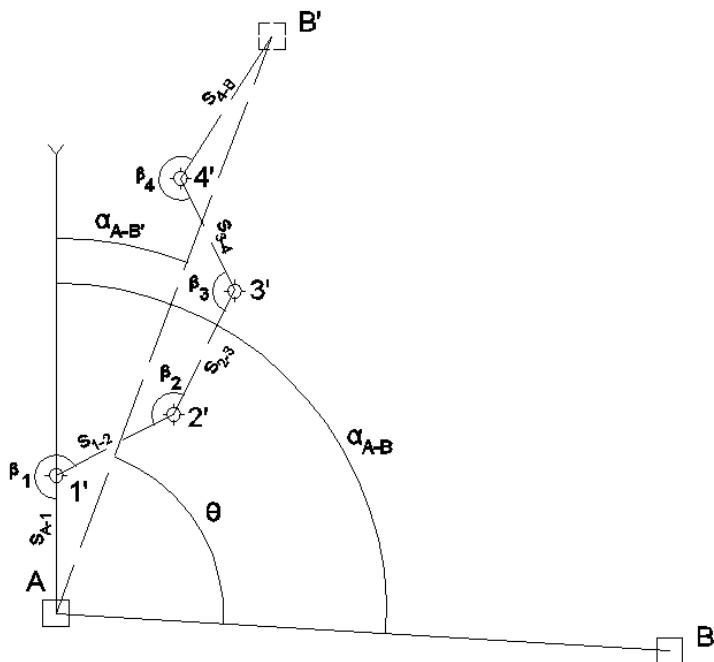
Рис. 2.2. Определение условных координат конечной точки теодолитного хода
