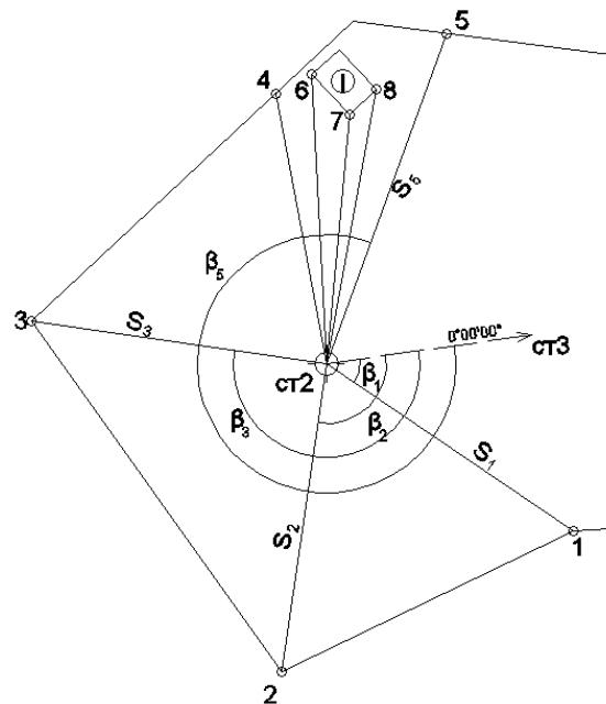
Рис. 3.6. Абрисы полевых измерений на станции 2
