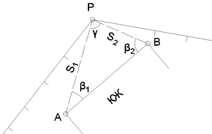
Рис 3.3. Процесс решения угловой засечки
