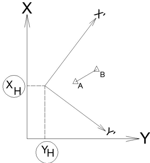
Рис. 1.3. Координаты начала условной системы координат в МСК
