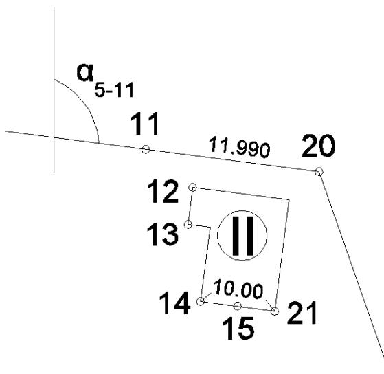
Рис. 3.9. Створный метод для определения координат точек 20 и 21
