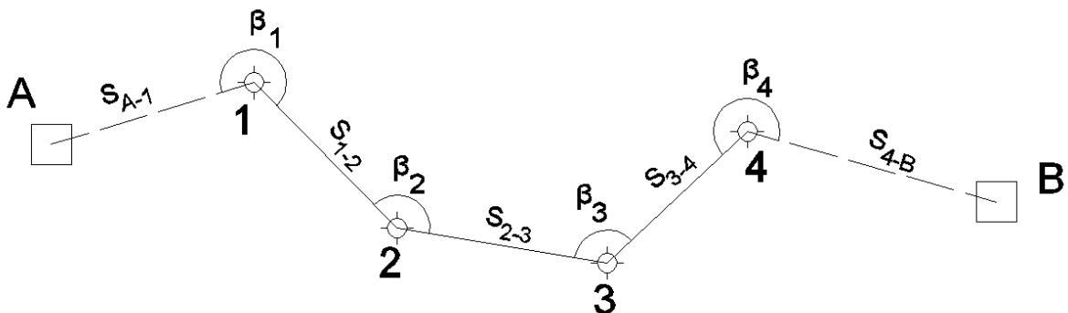
Рис. 2.1. Теодолитный ход с координатной привязкой
