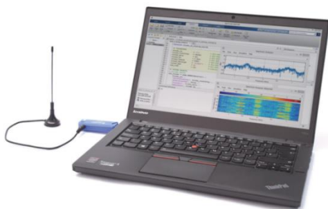
Рис. 78. Пакет для RTL-SDR System Toolbox в MATLAB (Simulink) [7]
