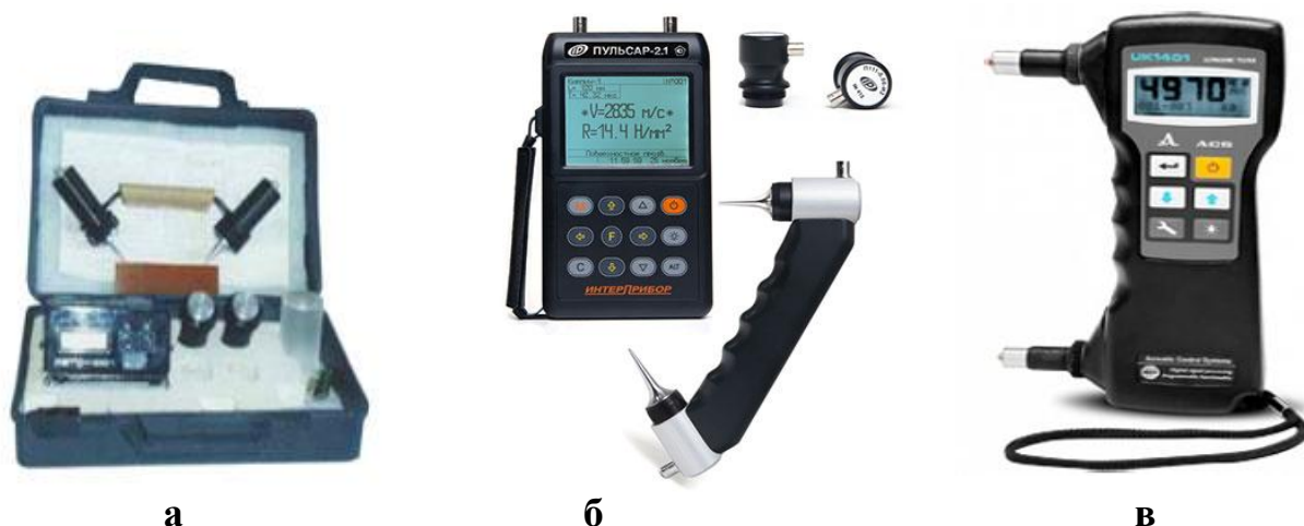
Рис.1.3. Внешний вид ультразвуковых приборов: а - БЕТОН-22; б - ПУЛЬСАР-2.1; в - УК1401М
