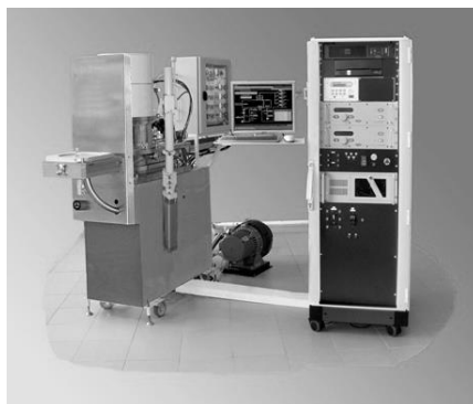
Рис. 1.13. Вакуумная установка плазменного травления «ПЛАЗМА ТМ-200»
