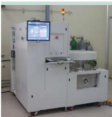
Рис. 3.1. Внешний вид установки CS-1000 Sputter & PVD Deposition System
