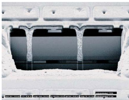
Рис. 2.6. Сквозные отверстия в кремнии
