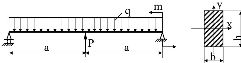
Задача 7. Стальная балка прямоугольного поперечного сечения ( $h = 20\text{см}$ ,  $b = 10\text{см}$ ) нагружена силой  $P$  и равномерно распределенной нагрузкой интенсивностью  $q$ . Определить допустимую величину  $q$ , если  $a = 2\text{м}$ ;  $[\sigma] = 120\text{Н/мм}^2$ .
