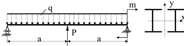
Задача 6. Проверить прочность балки, если  $[\sigma] = 160\text{МПа}$ . Принять  $a = 2\text{м}$ ;  $q = 4\text{кН/м}$ ;  $P = 20\text{кН}$ ;  $m = 30\text{кНм}$ ;  $h = 20\text{см}$ ;  $b = 12\text{см}$ .
