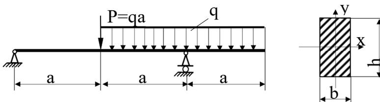
Задача 8. Определить максимальный прогиб, если  $q = 20\text{кН/м}$ ;  $a = 1\text{м}$ ;  $E = 2 \cdot 10^5\text{МПа}$ ;  $EJ_x = \text{const}$ , сечение балки - швеллер №14. Проверить жесткость балки, если  $[y] = 0,003a$ .
