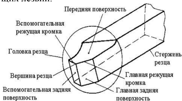
Рис. 13.2. Элементы режущей части прямого проходного резца
