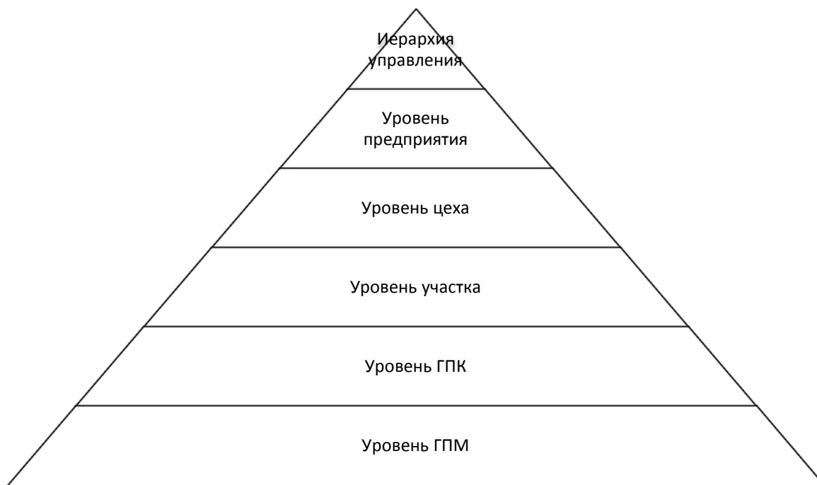
Рис. 4.3. Структура гибкого автоматизированного производства.
