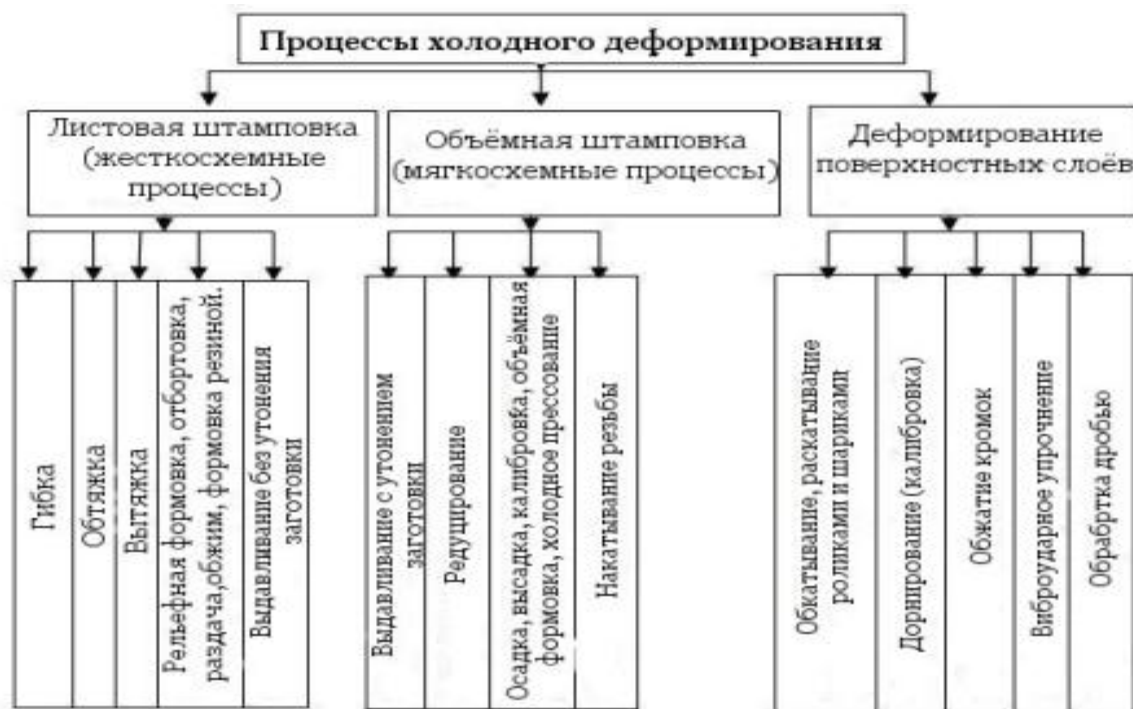
Рис. 7.1. Классификация основных процессов формообразования деталей холодным деформированием
