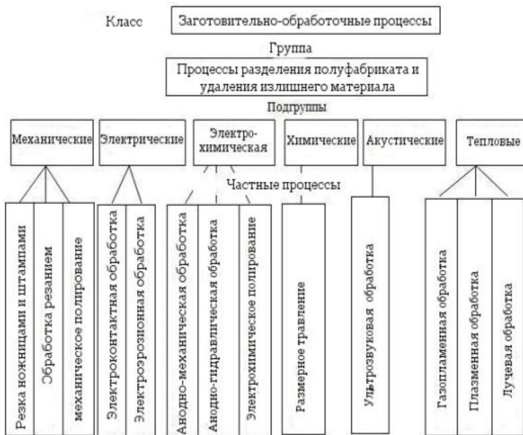
Рис. 6.1. Классификация процессов разделения полуфабриката и удаления излишнего материала
