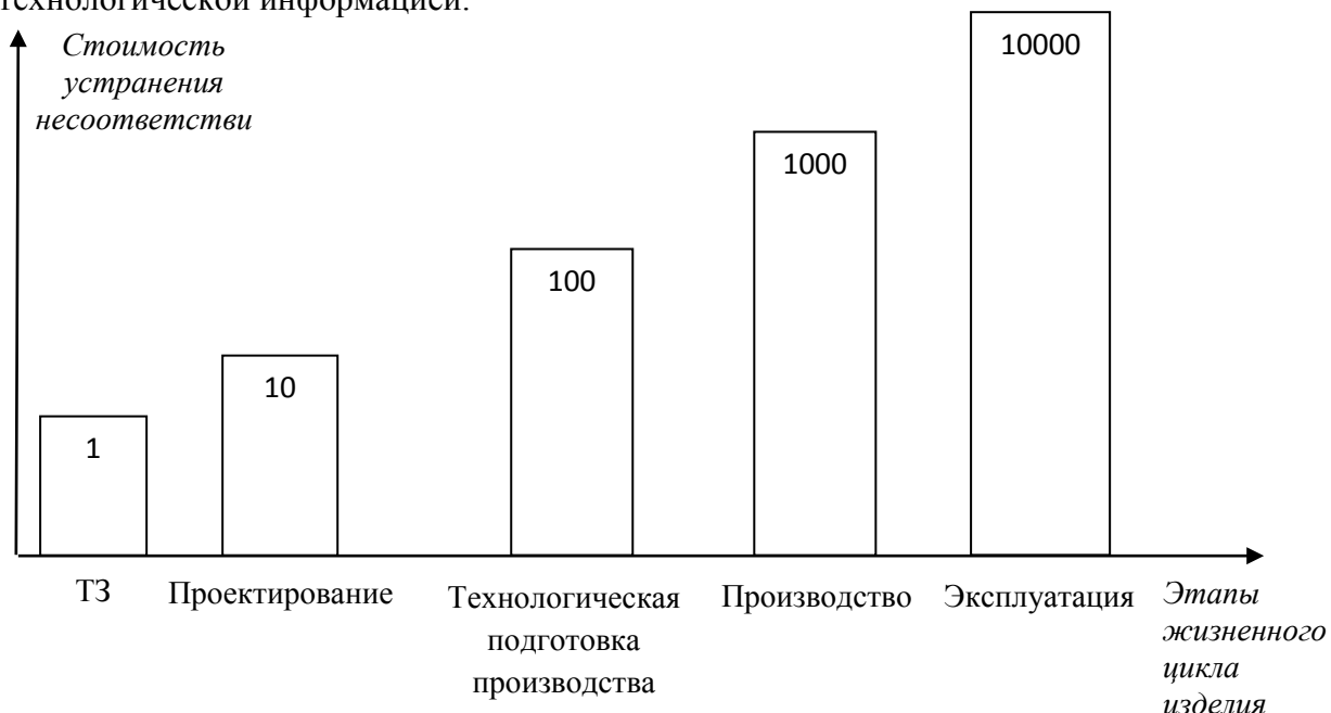
Рис. 2.5. График зависимости стоимости устранения несоответствия стандартам качества от этапа жизненного цикла изделия.
