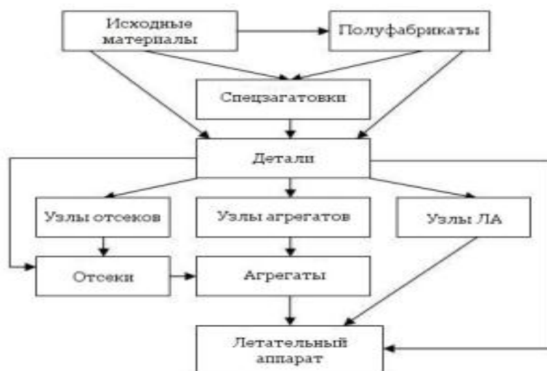
Рис. 9.1. Принципиальная схема преобразования исходных материалов в изделие.
