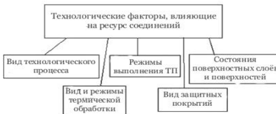
Рис. 10.6. Технологические факторы, влияющие на ресурс соединений.
