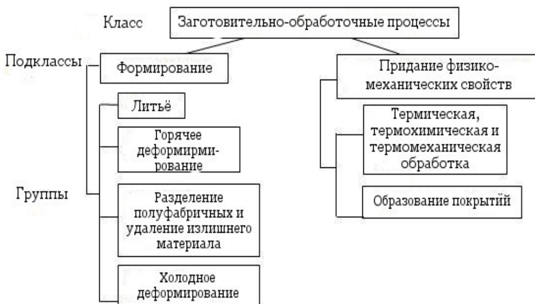
Рис.5.1 Классификация заготовительно-обработочных процессов
