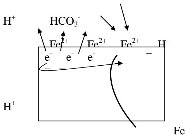
Схема электрохимической коррозии железа в кислой среде
