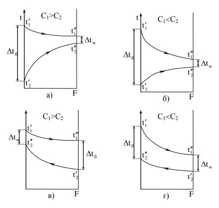
Рис. 3. Характер изменения температур теплоносителей, а) и б) – прямоток; в) и г) – противоток
