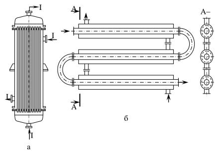
Рис.4. Принципиальные схемы ТОА: а – кожухотрубчатый ТОА; б – ТОА "труба в трубе"
