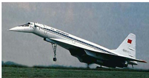
Рис. 3.10. Сверхзвуковой пассажирский самолет Ту-144 с изменяемой геометрией носовой части фюзеляжа
