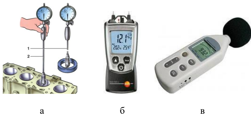
Рис. 6.2. Примеры измерительных приборов: а – нутромер для измерения внутренних линейных размеров; б - влагомер для измерения влажности древесины и строительных материалов; в – портативный шумомер для измерения уровня шума
