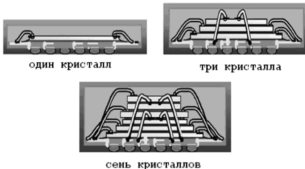
Рис.2.13. Стековые (stacked die) 3D БИС по технологии Non TSV с разваркой выводов и последующей упаковкой в единый BGA-корпус
