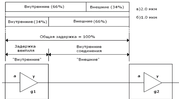
Рис.2.6. Внутренние и внешние задержки в БИС различного технологического поколения
