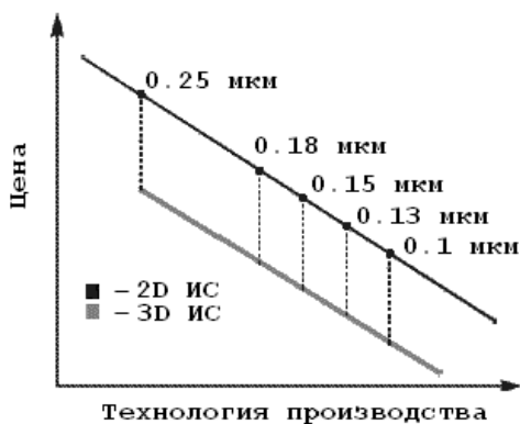
Рис.2.11. Возможности масштабирования в соответствии с законом Мура для 2D и 3D ИС
