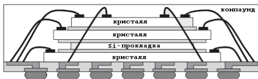
Рис.2.15. Стековые 3D БИС фирмы Intel (логика + два кристалла памяти) по технологии Non TSV с разваркой выводов. Логика – верхний кристалл
