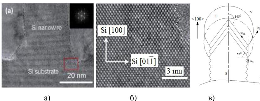
Рис. 16. ПЭМ-изображение ННК Si, выросшего в направлении  $<100>$  на Si-подложке (100) (а), увеличенное изображение участка этого кристалла (б) [164] и схема выращивания ННК в направлении  $<100>$  (в)
