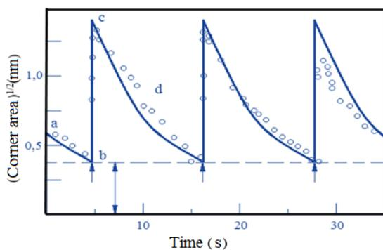
Рис. 31. Периодическое изменение площади усечения (фаски) со временем, определенная путем измерения площади жидкой капли Au-Si ниже границы Si/Au-Si [44]
