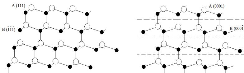
Рис. 25. Преобразование структуры цинковой обманки (слева) в структуру вюртцита (справа). Пунктирными линиями обозначены плоскости двойникования. Плоскости цинковой обманки A{111} и B{111} сравнимы с плоскостями A{0001} or wurtzite plane B {0001}
