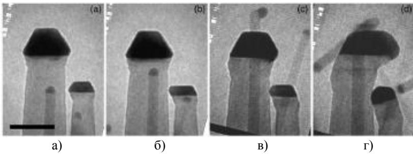
Рис. 13. Серия светлопольных изображений, полученных при выращивании *in situ* кремниевых ННК из дисилана с использованием наночастиц сплава AuAl: а) ННК в процессе роста при 575  $^{\circ}\text{C}$ ; б) Те же ННК через 81 с роста; в) через 290 с роста; г) ННК в процессе роста при 495  $^{\circ}\text{C}$  через 500 с. Темная линия – граница двойника, образовавшегося при изменении температуры. Масштабная линейка 25 нм [151]
