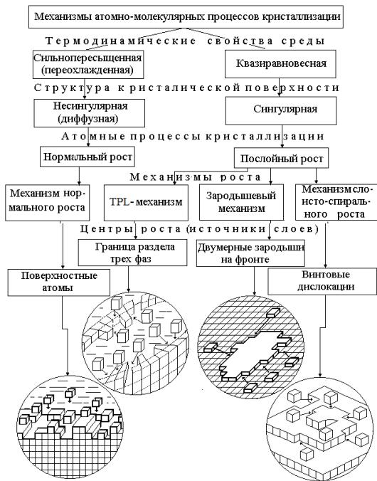
Рис. 2. ТЛ (TPL) - механизм в ряду моделей атомно – молекулярных процессов роста кристаллов
