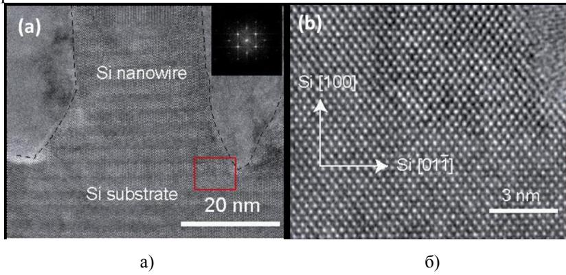
Рис. 3. ПЭМ-изображение ННК Si кристаллографической ориентацией  $<100>$ , выращенного на кремниевой подложке {100} темплатным методом, (а) и его увеличенное изображение (б) [61]
