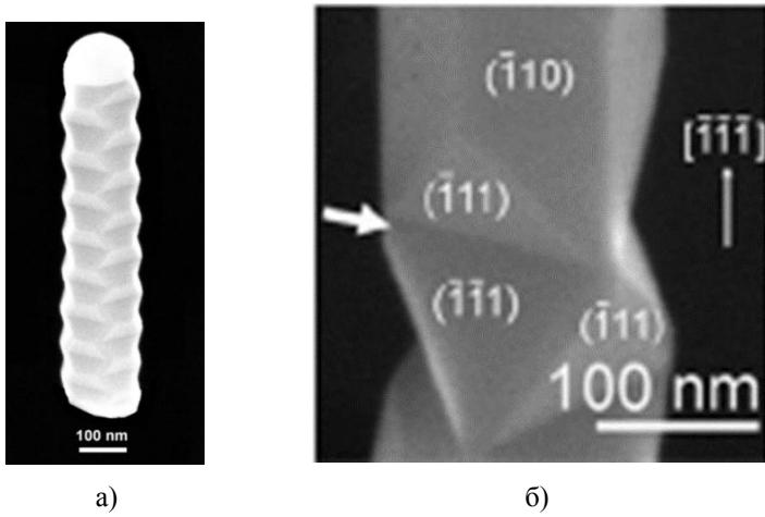
Рис. 35. «Паркетный» полисинтетический двойниковый ННК InAs, выращенный с Au-катализатором методом MOCVD при  $T=400^{\circ}\text{C}$ , (а) и РЭМ-изображение участка кристалла, содержащего полный октаэдр с пометкой граней семейства {111} (б) [244]
