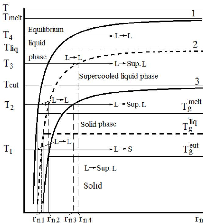
Рис. 22. Диаграмма фазового перехода жидкость  $\rightarrow$  кристалл при нуклеации под каплей двухкомпонентного катализатора в условиях роста ННК [186]
