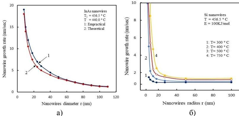
Рис. 10. Экспериментальная (1) и теоретическая (2) зависимости скорости роста ННК InAs от радиуса (температура роста  $T=440\text{ }^{\circ}\text{C}$ ) [144] (а) и теоретические зависимости (1-4) скорости роста ННК Si от радиуса [143] (б)
