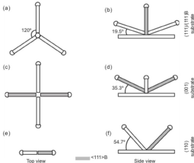
Рис. 17. Схематическая иллюстрация ННК  $<111>$ , эпитаксиально выращенных на ростовых подложках с различной кристаллографической ориентацией. ННК как элементарных полупроводников, так и соединений, объединены на одних и тех же рисунках с направлением  $<111>B$  и выделены серым цветом (a-f) [165]
