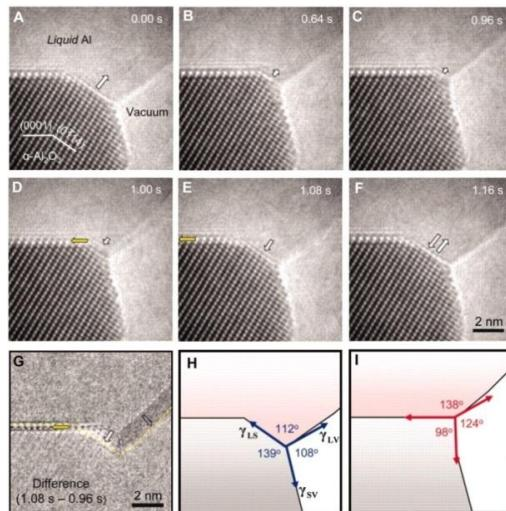
Рис. 30. Покадровая видеосъемка в ПЭМ окрестности ТЛ ННК  $\alpha\text{-Al}_2\text{O}_3$ , иллюстрирующая изменение площади усечения (A-G) и схема треугольника сил, соответствующих свободной поверхностной энергии границ раздела фаз (H, I) [117]
