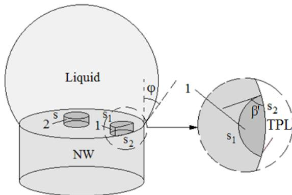
Рис. 20. Схема процесса нуклеации на фронте кристаллизации ННК под каплей катализатора: 1 - усеченный зародыш, примыкающий к ТЛ, 2 - круглый зародыш на грани фронта кристаллизации, вдали от ТЛ.  $\beta'$  - угол дуги окружности зародыша, примыкающего к ТЛ
