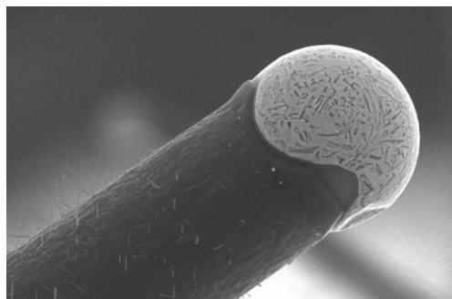
Рис. 23. РЭМ-изображение вершины ННК Si, выращенного в направлении <100>
