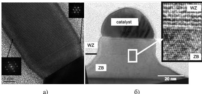
Рис. 29. Переход от вюрциттной структуры (основной кристалл) к кубической (область охлаждения) [3, 65] (а) и трансформация кубической структуры в гексагональную на начальной стадии роста ННК GaAs [3, 65] (б)
