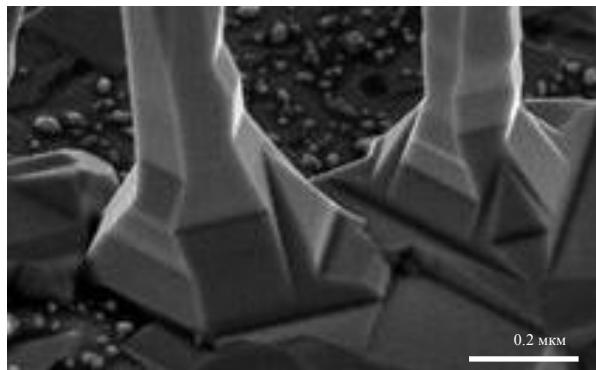
Рис. 36. Огранка боковой поверхности ННК Si, образованная по ПК-механизму
