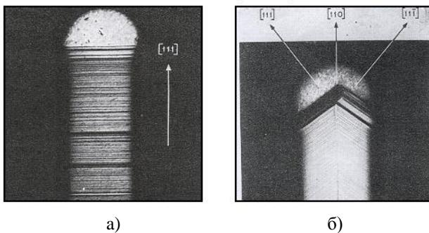
Рис. 28. Протравленное сечение НК Si {111} (а) и {110} (б), легированного фосфором в процессе изотермического роста с применением жидких капель Au-Si [2]. На фотографиях отчетливо видны примесные полосы
