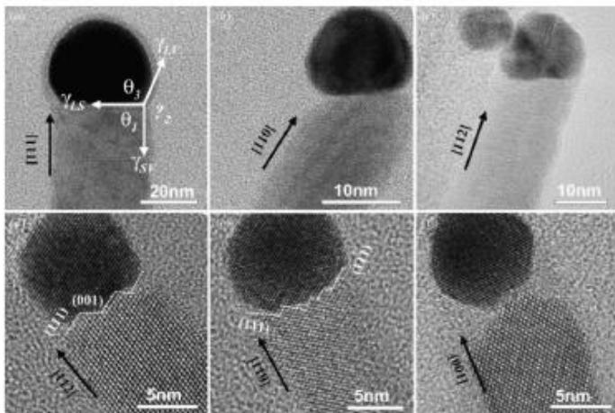
Рис. 18. TEM-изображения ННК ZnSe, выращенных вдоль направлений (a)  $<111>$ , (b) и (e)  $<110>$ , (c) и (d)  $<112>$  и (f)  $<001>$ . В целом Взаимосвязь между нанопроводом Au и ZnSe представляет собой либо одну (111) поверхность (a) - (c), либо комбинацию самой низкой энергии (111) и (001) поверхностей (d) - (f) [165]
