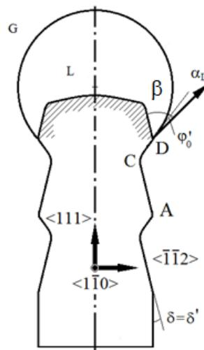
Рис. 37. Схема фасетирования боковой поверхности ННК по ПЖК- механизму
