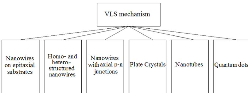
Рис. 4. Основные виды кристаллических структур, получаемых с помощью ПЖК-механизма
