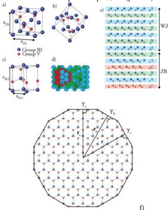
Рис. 32. Элементарная ячейка ZB полупроводникового соединения в различных ориентациях (а, б). Элементарная ячейка WZ (с). Плотноупакованные слои: кубическая упаковка слева и гексагональная упаковка справа (д). ZB и WZ ячейки в одной и той же структуре, демонстрирующие плотноупакованые последовательности укладки (е). Двумерный кристалл с равновесной кристаллической формой, которую можно описать теоремой Вульфа (ф) [234]
