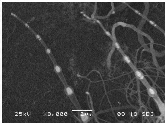
Рис. 6. Радиальная периодическая неустойчивость роста ННК Ge в системе Au-Ge с периодическим захватом катализатора
