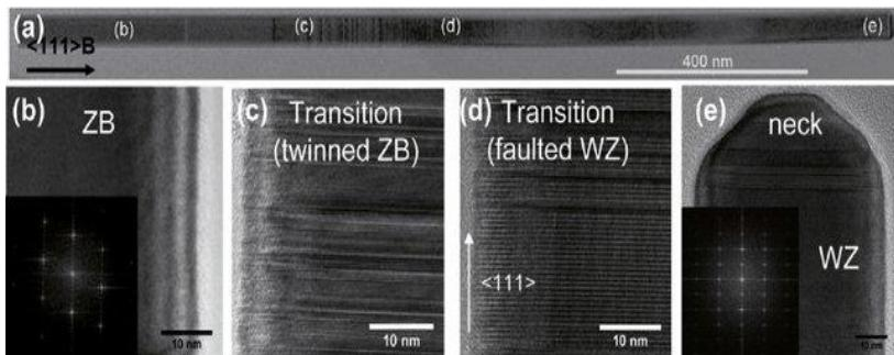
Рис. 5. ПЭМ-изображение нанопроволоки GaAs [94]. Образец был выращен на покрытой оксидом кремния подложке при 630 °С. Нижняя часть нанопроволоки имеет кристаллическую структуру ZB с очень низкой плотностью дефектов упаковки в сегменте. Переходные области (а-е) показывают появление сначала двойниковой плоскости, затем дефектов упаковки. Верхняя часть - чистый WZ
