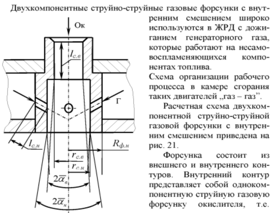
Рис. 21. Расчётная схема двухкомпонентной струйно-струйной газовой или газожидкостной форсунки с внутренним смешением
