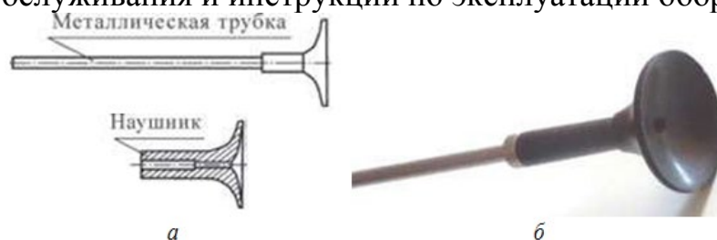
Рис. 11.1. Технический стетоскоп: а) схема; б) общий вид
