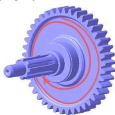
Рис. 11.5. Концентрический способ осмотра детали
