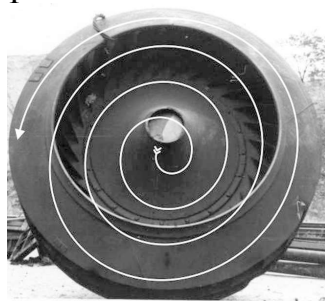
Рис. 11.6. Эксцентрический способ осмотра детали
