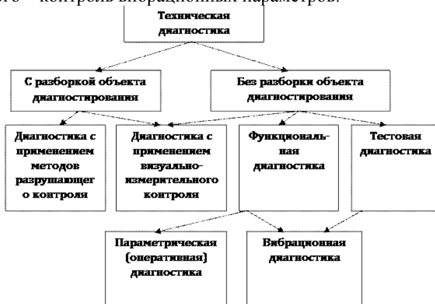
Рис. 11.8. Классификация видов технической диагностики
