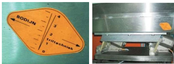
Рис. 11.3. Установка мерного клина для измерения амплитуды колебания вибрационного дозатора
