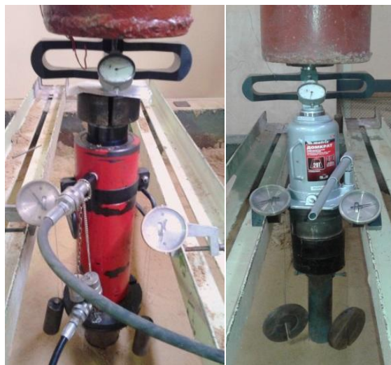
Схема установки для испытания цилиндрической модели фундамента с 50т и 20т гидравлическим домкратом
