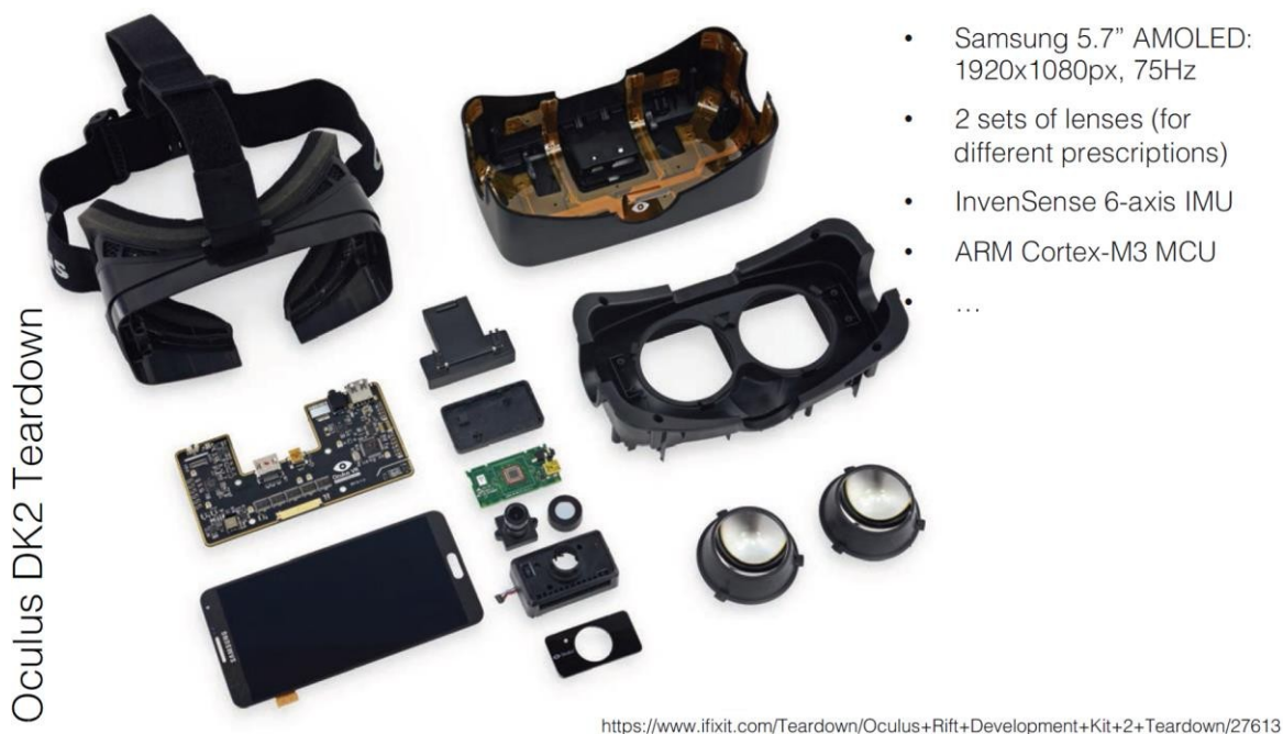
Рис. 3. Компонентная база очков виртуальной реальности
