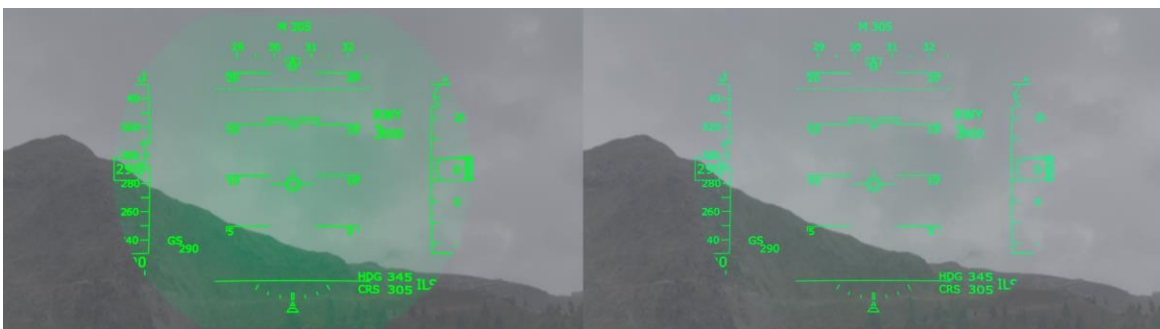
Рис. 17. Изображения, видимые на индикаторе на лобовом стекле в реальных условиях
