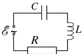
при которой в цепи наступит резонанс. Найти действующие значения силы тока  $I$  и напряжений  $U_R, U_L, U_C$  на всех элементах цепи при резонансе, если при этом действующее значение ЭДС  $\mathcal{E}=30 \text{ В}$ .
