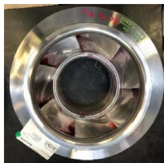
Рис. 6. Проверка капиллярным методом неразрушающего контроля
