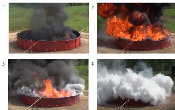
Рис. 4. Испытания по тушению макета топливного резервуара РВС-1000
