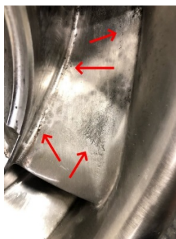
Рис. 1. Износ лопаток рабочего колеса
