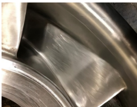
Рис. 5. Шлифование поверхности и восстановления геометрии
