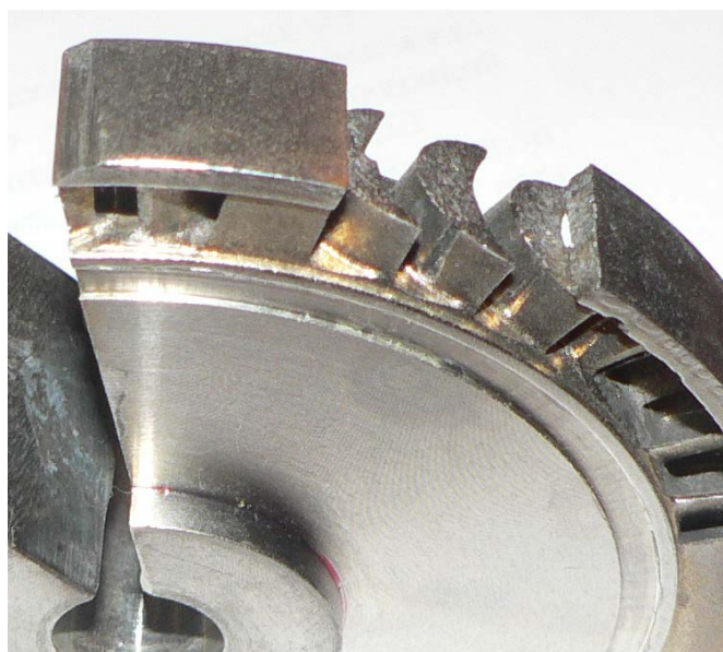
Рис. 1. Настроечные образцы для электроэрозионного прошивания канала
